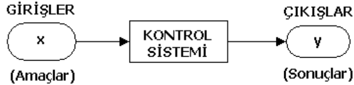
Şekil 5.1. Basit bir kontrol sisteminin blok diyagramı
