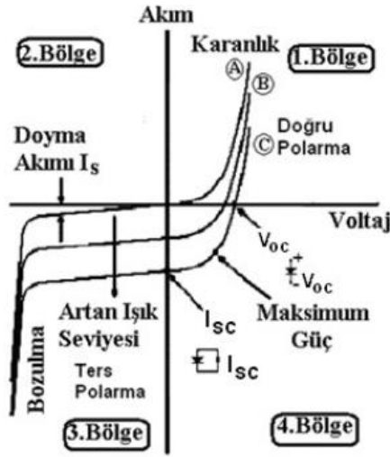
Şekil 2.8. Foto diyotun akım-voltaj karakteristikleri
