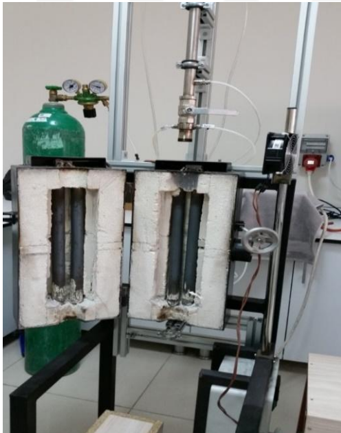
Şekil 3.4. Hızlı piroliz deney düzeneği
