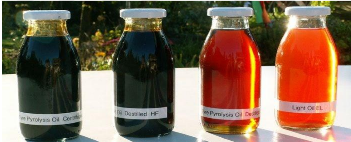
Şekil 2.5. Hızlı piroliz ürünü biyoyağın görünüşü
