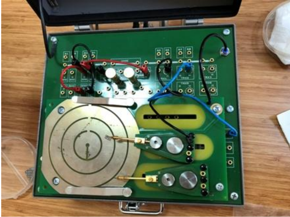
Şekil 3. 4 KEITHLEY 4200-SCS cihazı ile Organik arayüzeli Al/ST/n-InP diyotunun oda sıcaklığında Işık (ışık gücü 100 \text{ mW/cm}^2 ) ve Karanlık ortamda ölçüm düzeneği
