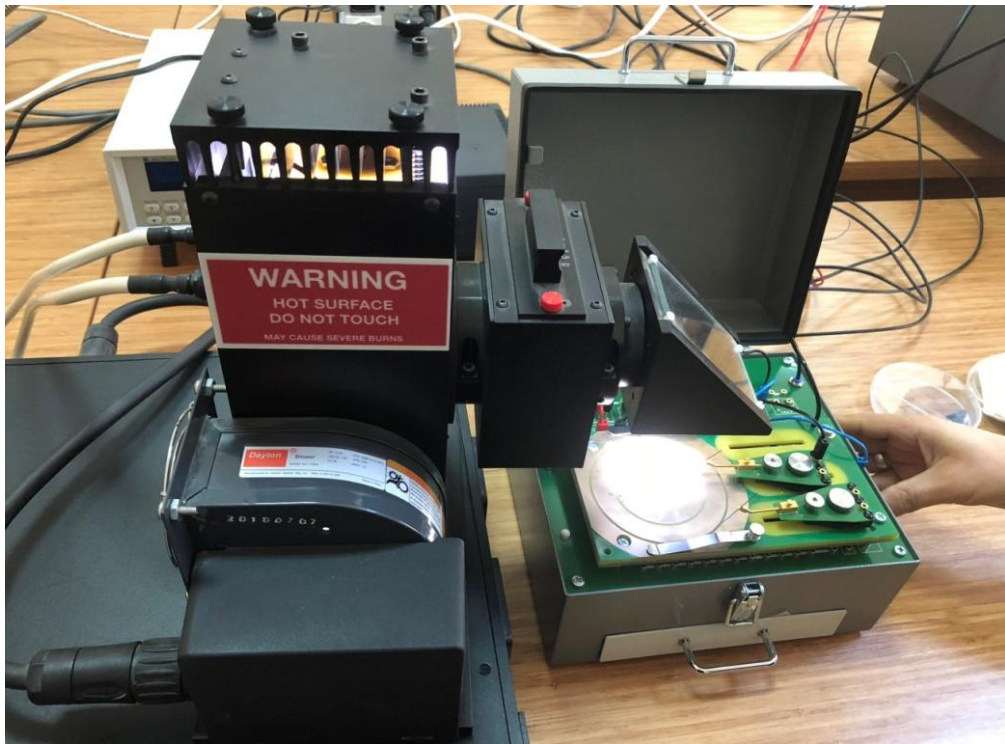
Şekil 3. 6 Organik ara yüzeyli Al/ST/n-InP diyotunun oda sıcaklığında 100 \text{ mW/cm}^2 gücünde solar simülatörü ile ölçüm düzeneği
