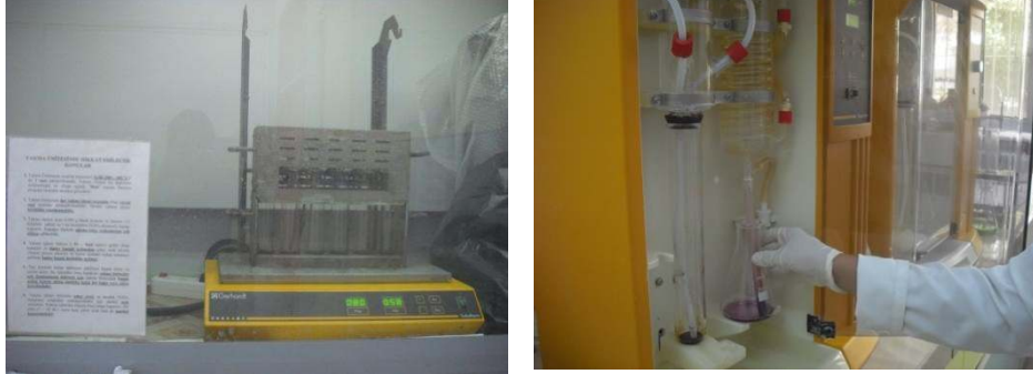
Şekil 3.17. Bitki yapraklarında azot (N) analizi Khjeldal yönteminin uygulanması
