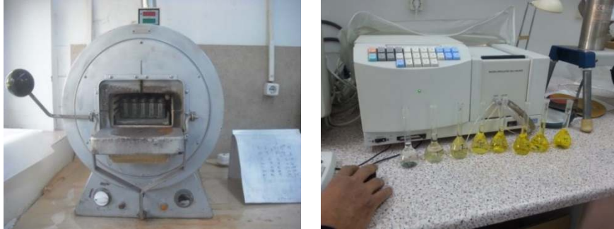
Şekil 3.16. Yapraklarda makro ve mikro element analizlerinde kullanılan kül fırını ve Atomik Absorpsiyon Spektrometre cihazından görüntüler
