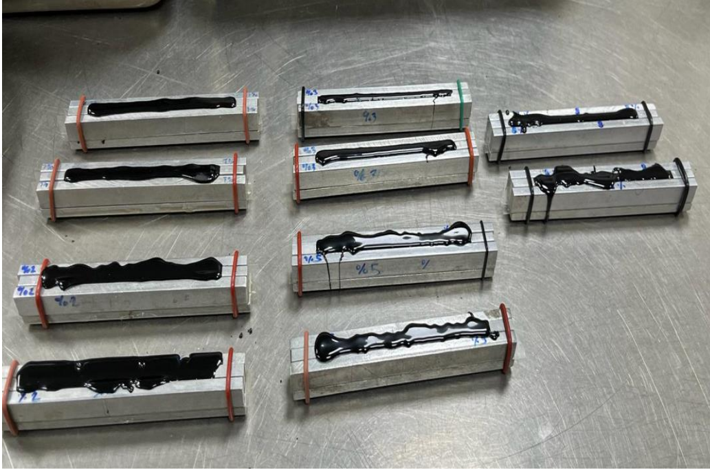
Şekil 4.16. Bitüm dolu kiriş numuneleri
