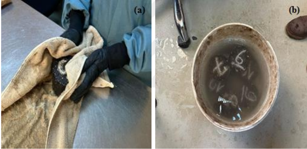
Şekil 5.21. Doygun yüzey kuru numunelerinin hazırlanışı
