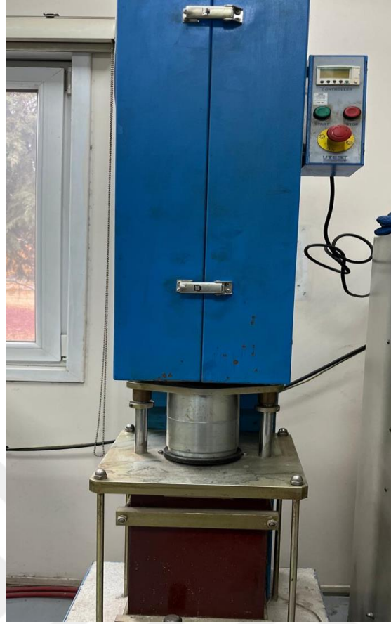
Şekil 4.18. Marshall deney tokmağı
