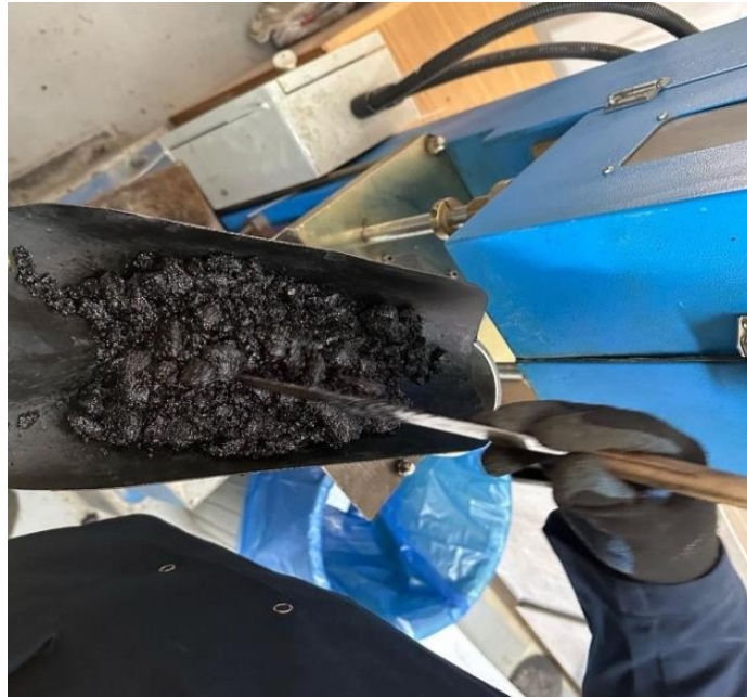
Şekil 5.19. Karışımın briket kalıplarına dökülmesi
