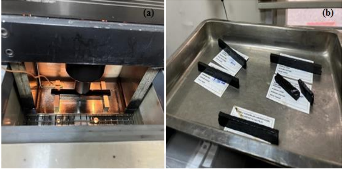
Şekil 4.17. (a) Yüklemeye maruz kalan numunenin yerleşimi (b) Deney sonrası kiriş numune görselleri
