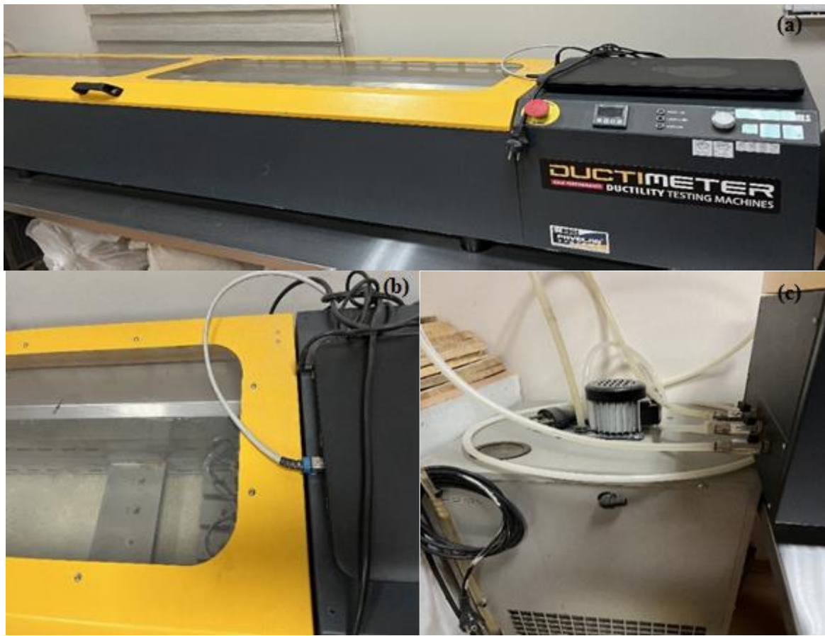
Şekil 4.9. (a) Düktilite cihazı (b) Cihaza tablaların yerleştirildiği üst kısım (c) Düktilite cihazı su haznesi
