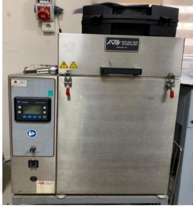
Şekil 4.14. PAV basınçlı yaşlandırma kabı
