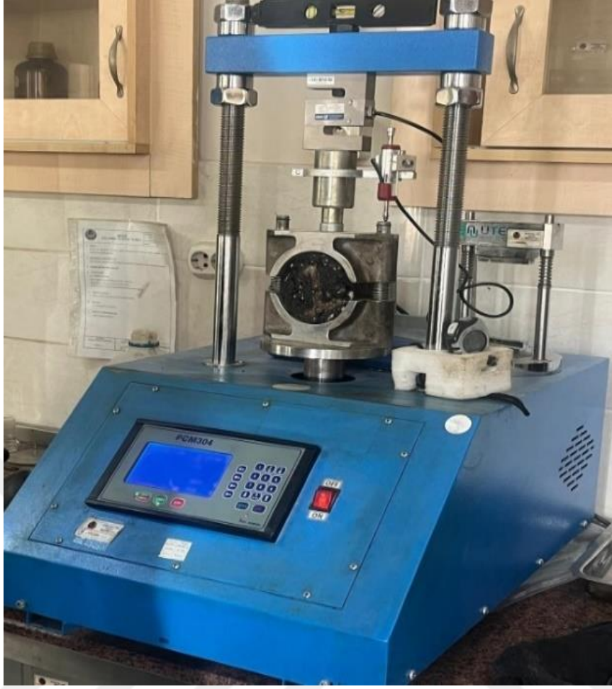
Şekil 5.22. Briketlere uygulanan Marshall yüklemesi
