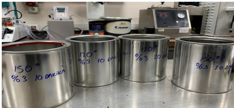
Şekil 5.1. Farklı karıştırma süre ve sıcaklığında hazırlanmış modifiye bitümler
