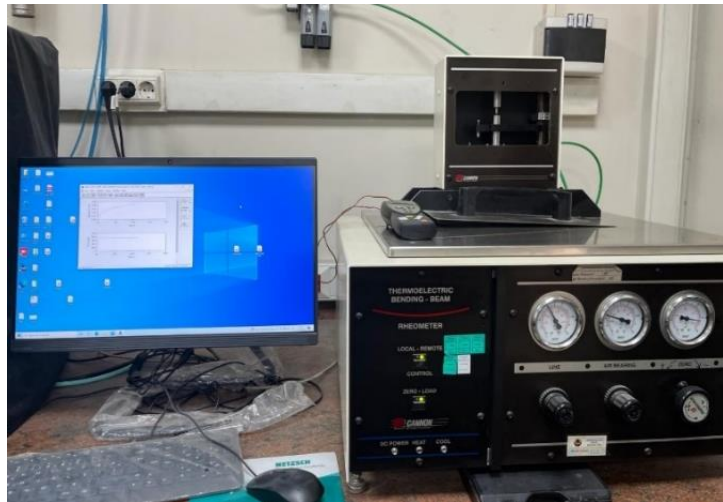
Şekil 4.15. BBR deney cihazı ve bilgisayar sistemi
