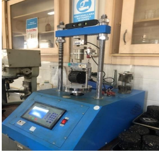
Şekil 5.53. Briket yanal yüklemesi
