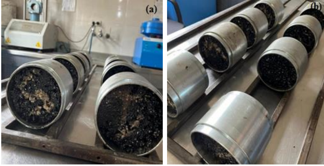
Şekil 5.20. Kalıplara dökülmüş briket numuneleri
