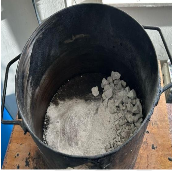
Şekil 5.17. Agreganın belirlenen gradasyona göre hazırlanması
