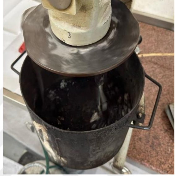
Şekil 5.18. Bitüm ve agreganın karıştırılması
