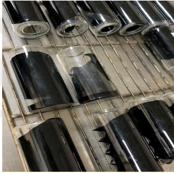
Şekil 4.12. RTFOT için hazırlanmış bitüm dolu cam şişeler
