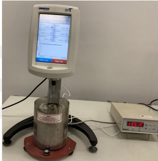
Şekil 4.5. Brookfield viskozite test cihazı
