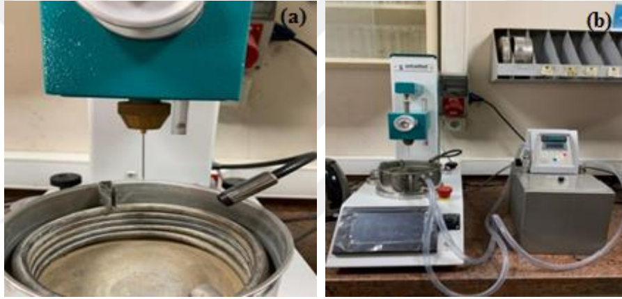
Şekil 4.6. (a) Penetrasyon iğnesi (b) Penetrasyon test cihazı
