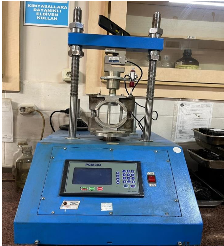
Şekil 4.19. Marshall stabilite ve akma cihazı
