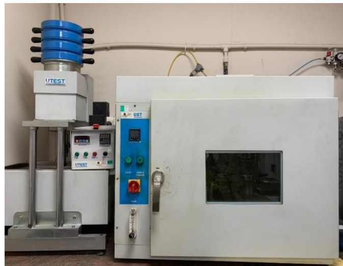
Şekil 4.13. RTFOT ısıtma kabı
