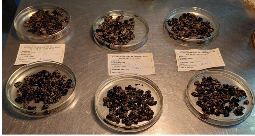
Şekil 5.47. Saf , %2 ve %5 OEKB katkıli bitümlü karışım numunelerinin soyulma görselleri
