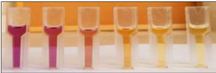
Şekil 3.18. Kalibrasyon için kullanılan standartların renk değişimleri. Mor renge sahip DPPH ortamda antioksidan bulunduğunda onlarla reaksiyona girerek sarı renge dönüşmektedir
