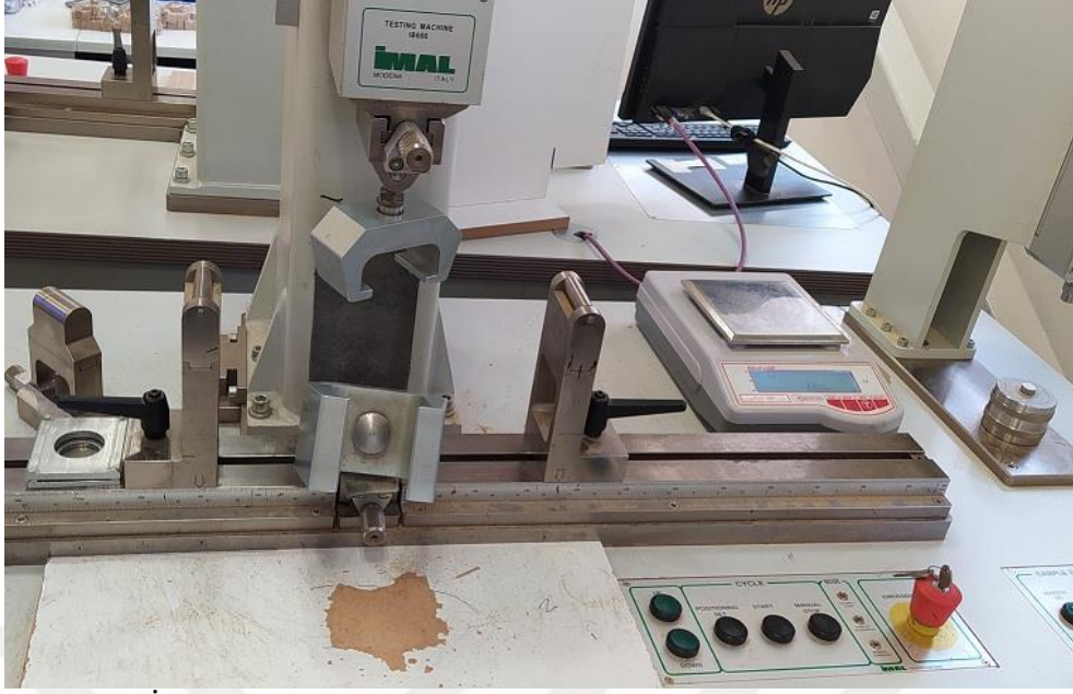
Şekil 3.9. İmal IB600 test ekipmanı
