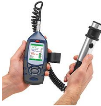
Şekil 3.13. PCE CEL – 712/K1 tozuma ölçüm test aparatı
