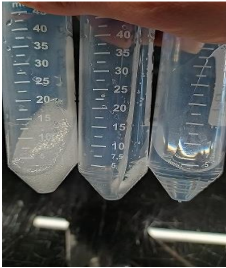
Şekil 3.7. IPTES:PEG200 sistemi 24 saat (solda); IPTES:PEG400 sistemi 52 saat (ortada); IPTES:PEG600 sistemi 72 saat (sağda)
