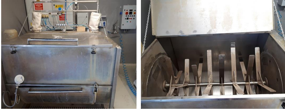
Şekil 3.2. Lif tutkallama mikseri; (solda) genel görünüm, (sağda) çırpıcı kollar
