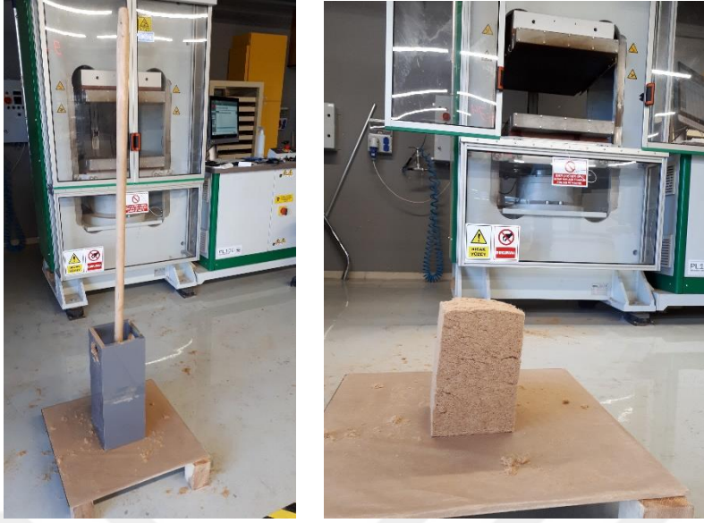
Şekil 3.4. (a) lif kalıplama ve pres ünitesi; (b) 15x15 cm levha için serme matı şeklinde ön-form verilmiş lifler
