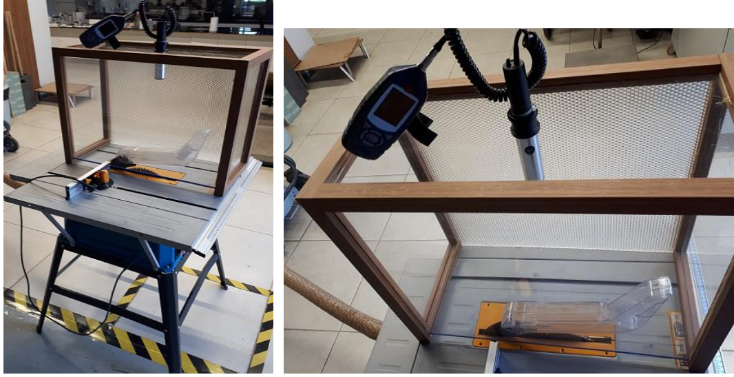
Şekil 3.14. Tozuma ölçümleri için yatar testere ünitesi, CEL-712/K1 cihazı ve kabin
