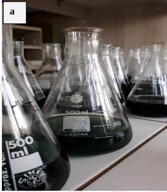
Şekil 3.6. Organik madde analiz aşamalarından görüntüler; a) titrasyon sonrası; b) kimyasalların hazırlanması
