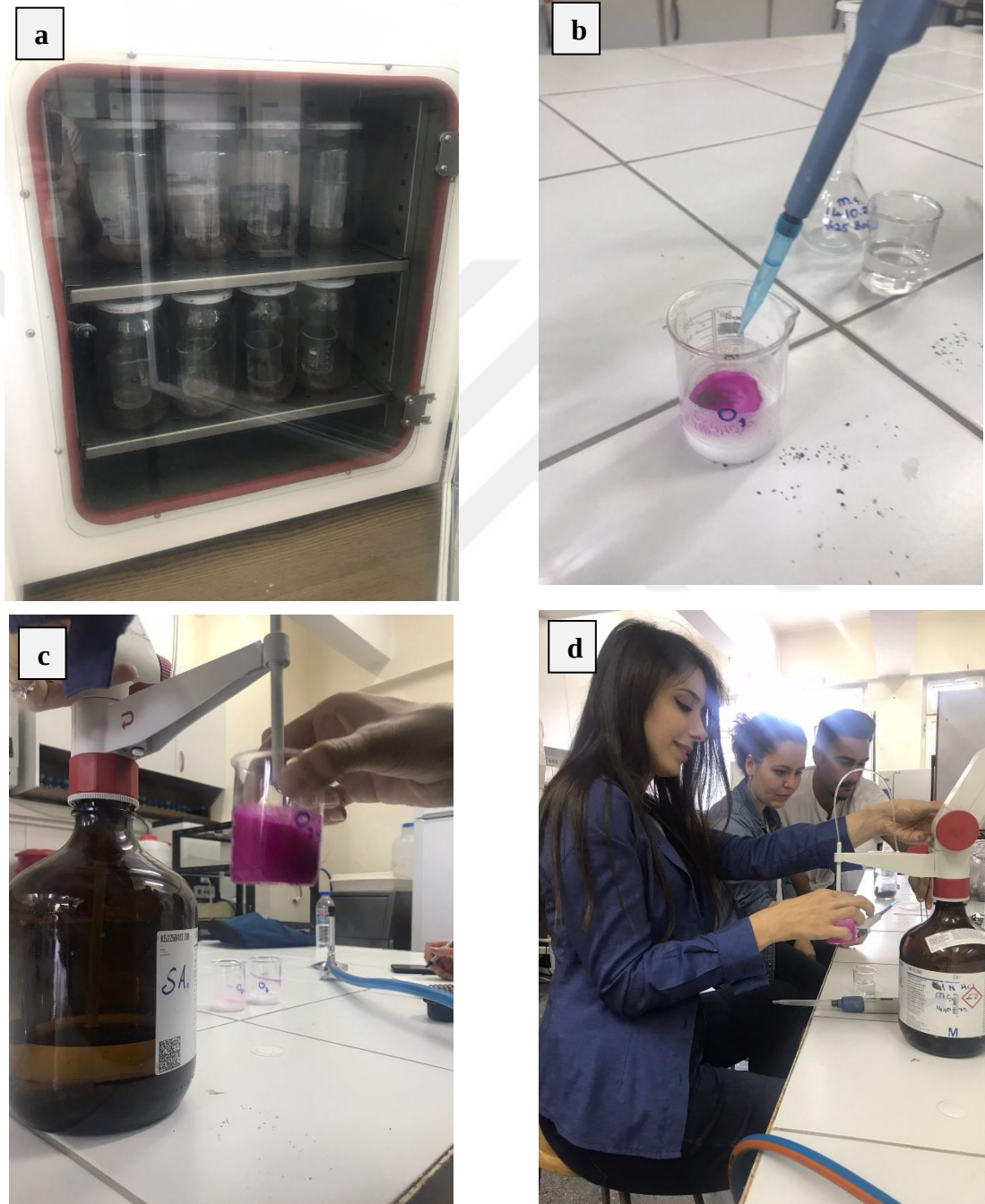
Şekil 3.10. Mikrobiyal biyokütle-C analizi aşamalar; a) inkübasyon; b) fenolfitaleyn ilavesi; c) 1 N HCl ilave anı; d) titrasyon aşaması
