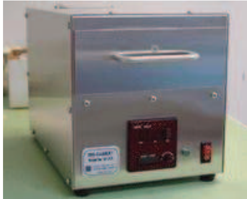
Şekil 3.5. UVO marka (Cleaner model no 42-220) ozonla temizleme cihazı
