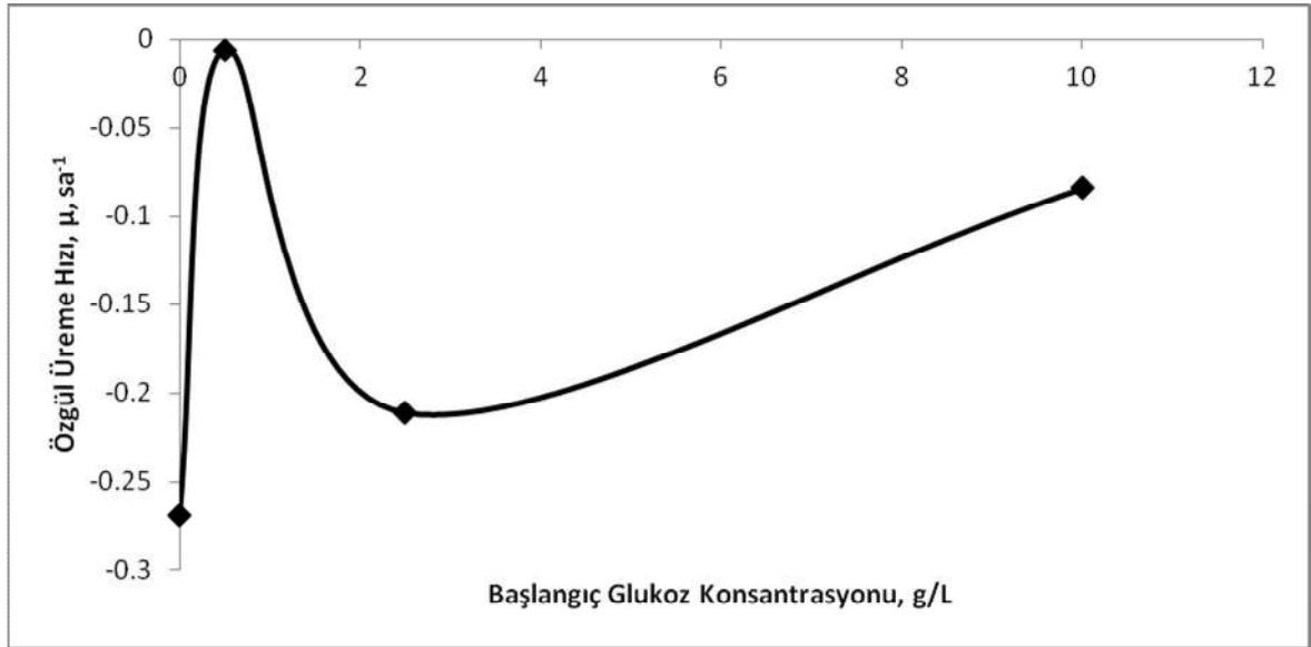
Şekil 5.12. P. fluorescens 'in Özgül Üreme Hızının Başlangıç Glukoz Konsantrasyonu ile Değişimi (pH=7; T=40 °C; C F0 =5mg/L Phosmet; V R =150mL; KH=150rpm)
