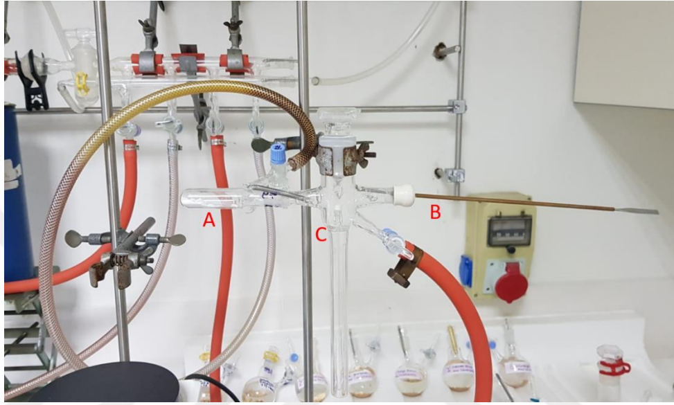
Şekil 4.4. \text{Me}_4\text{Mg}_4(\text{O}^i\text{Pr})_4 Bileşiğinden \text{N}_2(\text{g}) Altında TGA için Numune Alma İşlemi
