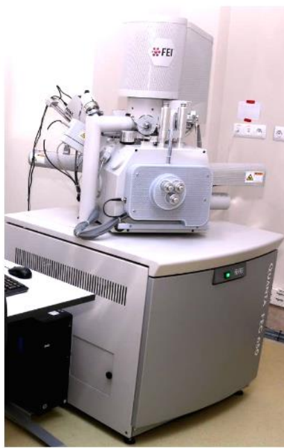
Şekil 3.7. Quanta 650 Field Emission SEM analiz cihazı ve teknik özellikleri
