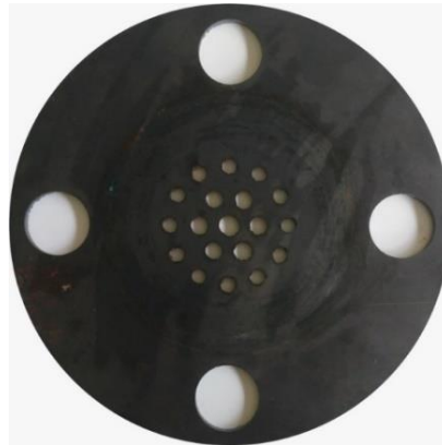
Şekil 3.14. İmal edilen 1x6x12 akış şartlandırıcı test plakası
