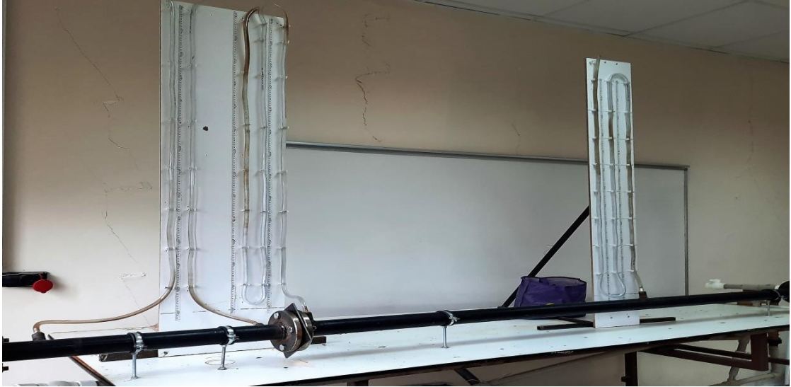
Şekil 3.2. Orifis plaka öncesi tam gelişmiş akış için deney düzeneği (standart orifis akışı)
