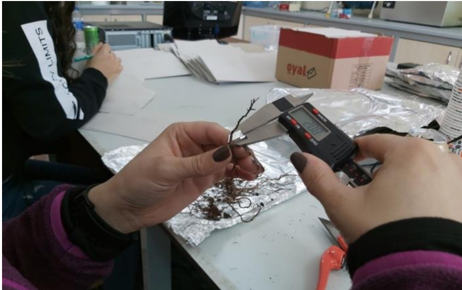
Şekil 18. Kök boğazı çapı ölçümü
