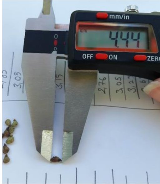
Şekil 8. Tohum boyunun dijital kumpas ile ölçülmesi
