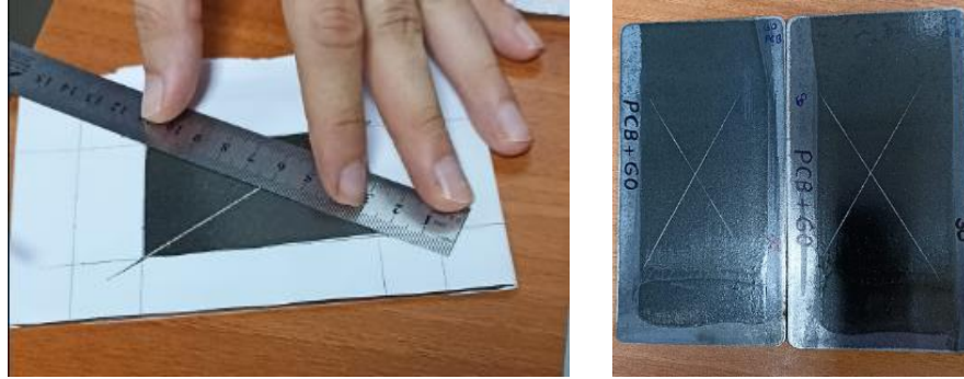
řekil 3.17. Tuz testi cihazına apraz olarak izilip konulan numune rnekleri.
