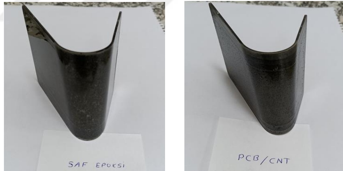
Şekil 3.12. Konik bükme uygulanan saf epoksi ve hibrit EPKS/KNT numunesi.
