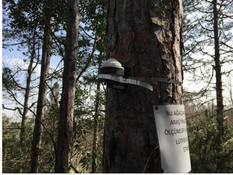
Şekil 3.6: EMS DR26 model çap artımı ölçer.
