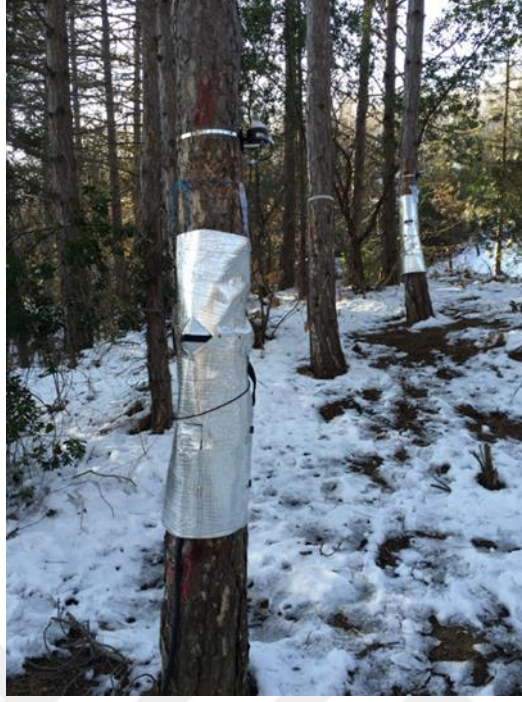
Şekil 3.4: Yansıtıcı köpükler kullanılarak sensörlerin güneşin doğrudan etkisinden ve sıcaklığı etkileyebilecek etmenlerden korunması ve izolasyonun sağlanması.
