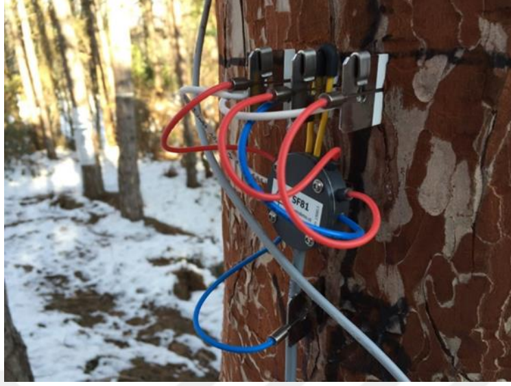
Şekil 3.2: Bitki özsuyu akış ölçüm sisteminin elektrotlarının ve ısı ölçer problemlerinin örnek ağaç üzerindeki görünümü.
