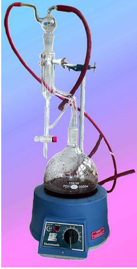
Şekil 2.3. Clevenger tipi subuharı destilasyon düzeneği
