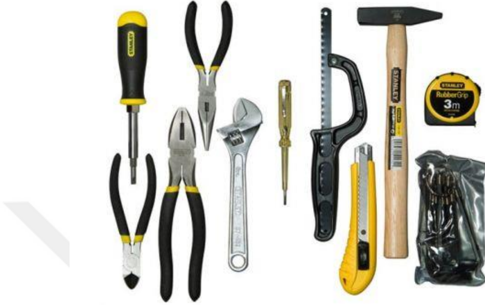
Şekil 15. Mobilya üretiminde kullanılan çeşitli el aletleri
