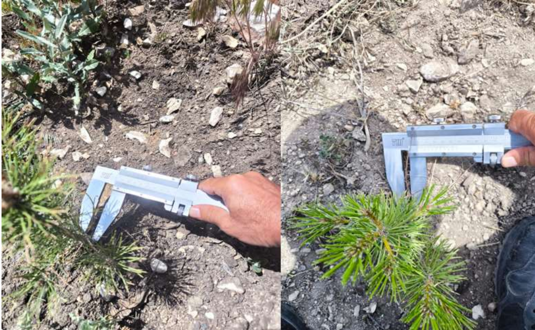
řekil 3.3 Karaçam fıdan kök boğazı çapının ölçümü
