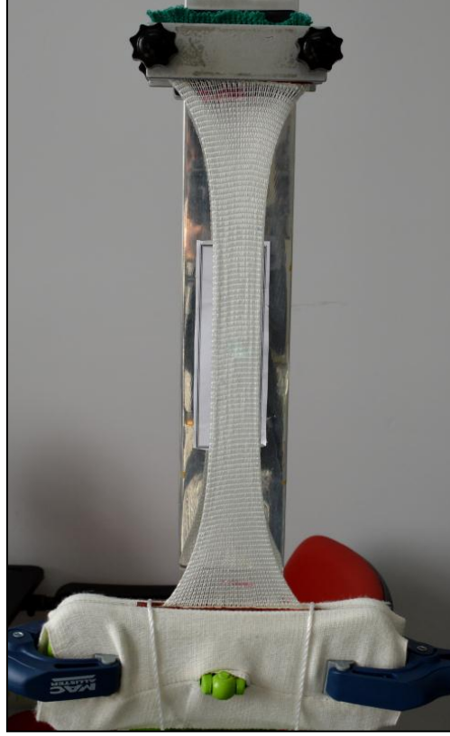
Şekil 2.7 Yük uzama testi için kumaş uzama özellikleri ölçüm düzeneği
