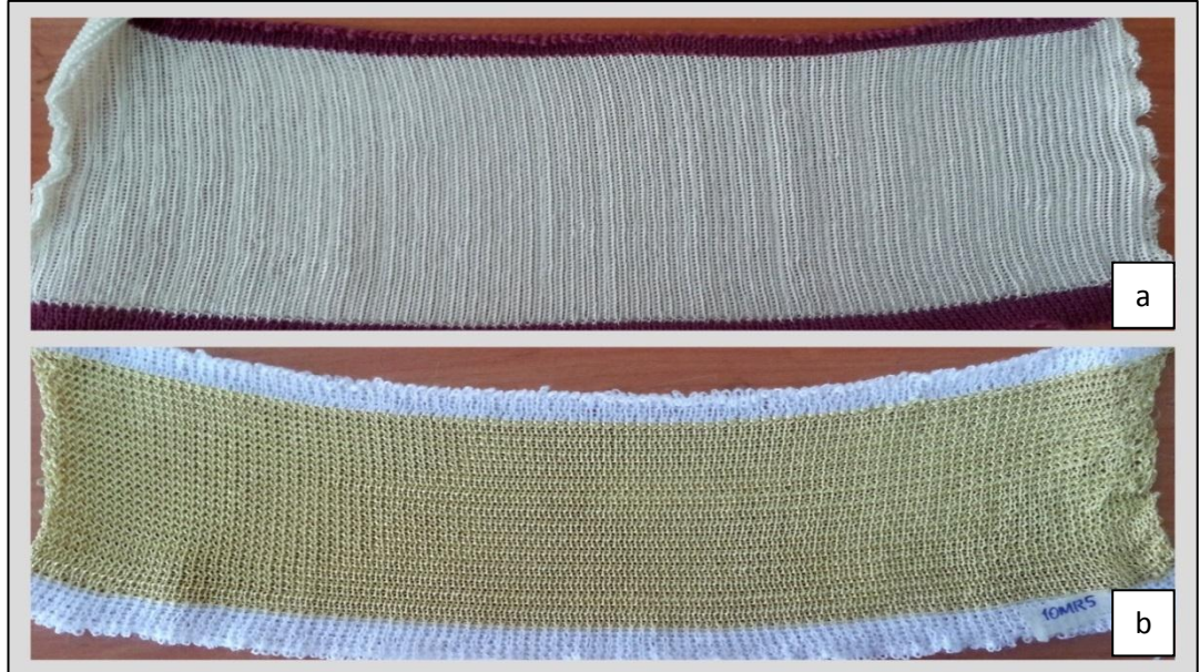
Şekil 2.5 Enine yönde ör÷lmüş numuneler (a. E-cam lifi numunesi b. Aramid lifi numunesi)
