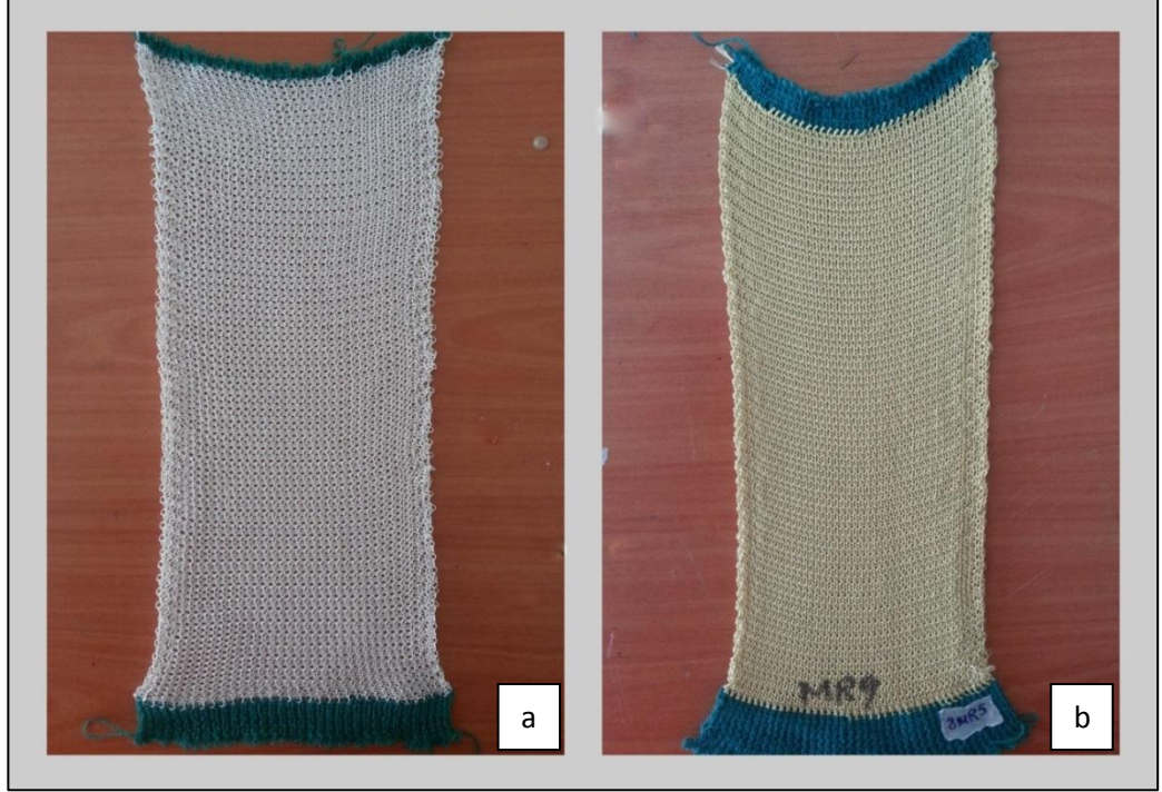
Şekil 2.4 Boyuna yönde ör÷lmüş numuneler (a. E-cam lifi numunesi b. Aramid lifi numunesi)
