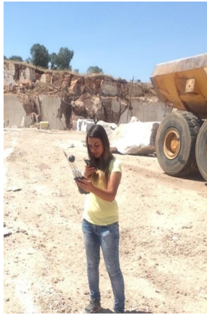
Resim 3.13 DELTA OHM-HD 32.3 traverten ocağı termal konfor ölçümü.
