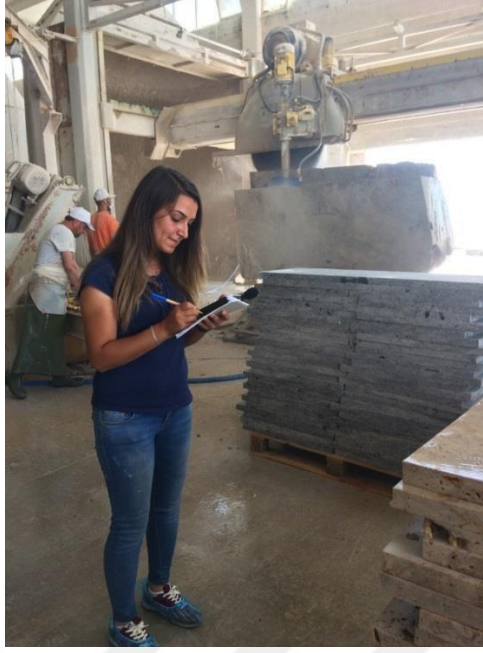
Resim 3.12 Testo 815 ile traverten fabrikası gürültü ölçümü.
