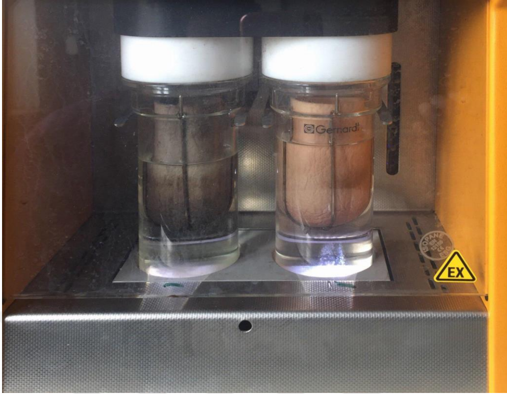
Şekil 3.1. Özütleme İşlemi İçin Kullanılan Basınçlı Ekstraksiyon Cihazı
