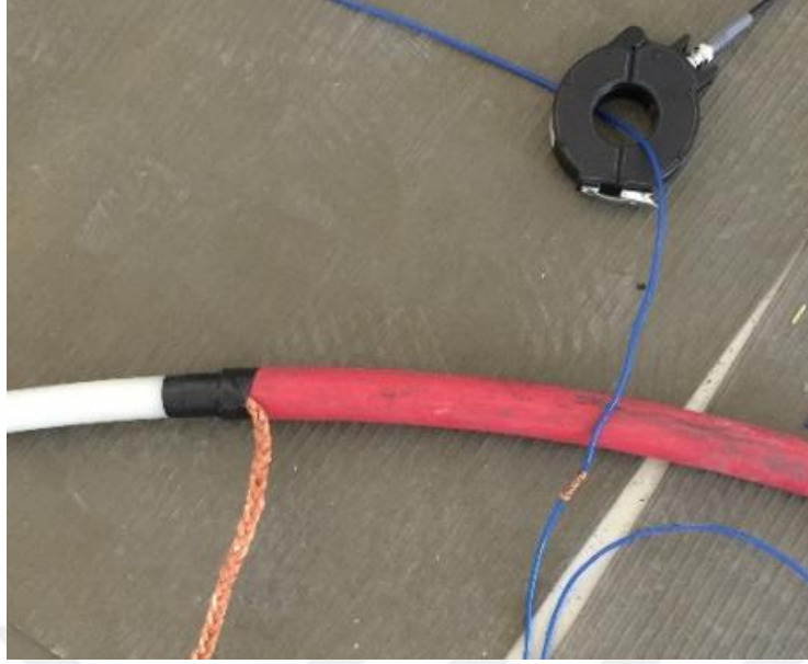
Resim 3.3 HFCT ile kablodaki KB sinyallerini ölçme işlemi.
