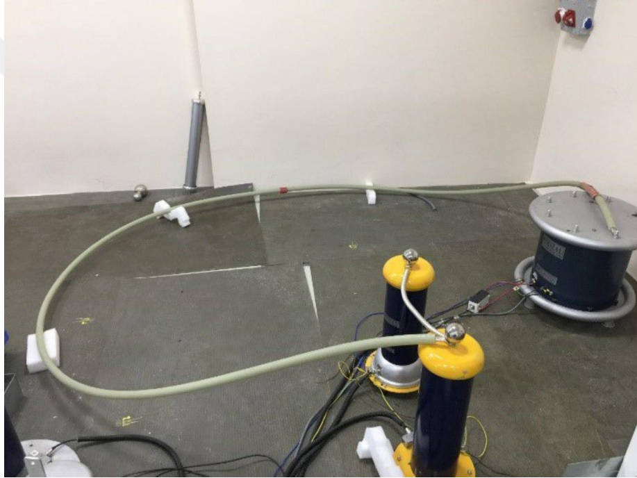
Resim 3.5 Kablo konumlandırma deney düzeneğinin görünümü.
