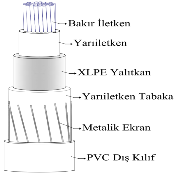
Şekil 3.7 Kullanılan XLPE kablunun iç yapısına ait grafik çizim.
