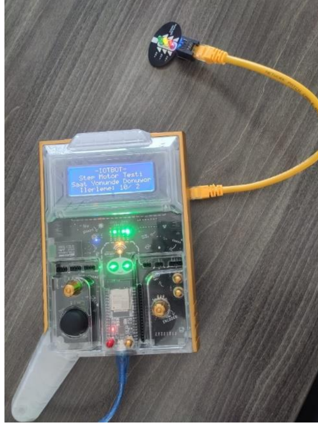
Şekil 6.4. Ek sokete takılan trafik ışığı modülü ve kartın görüntüsü.
