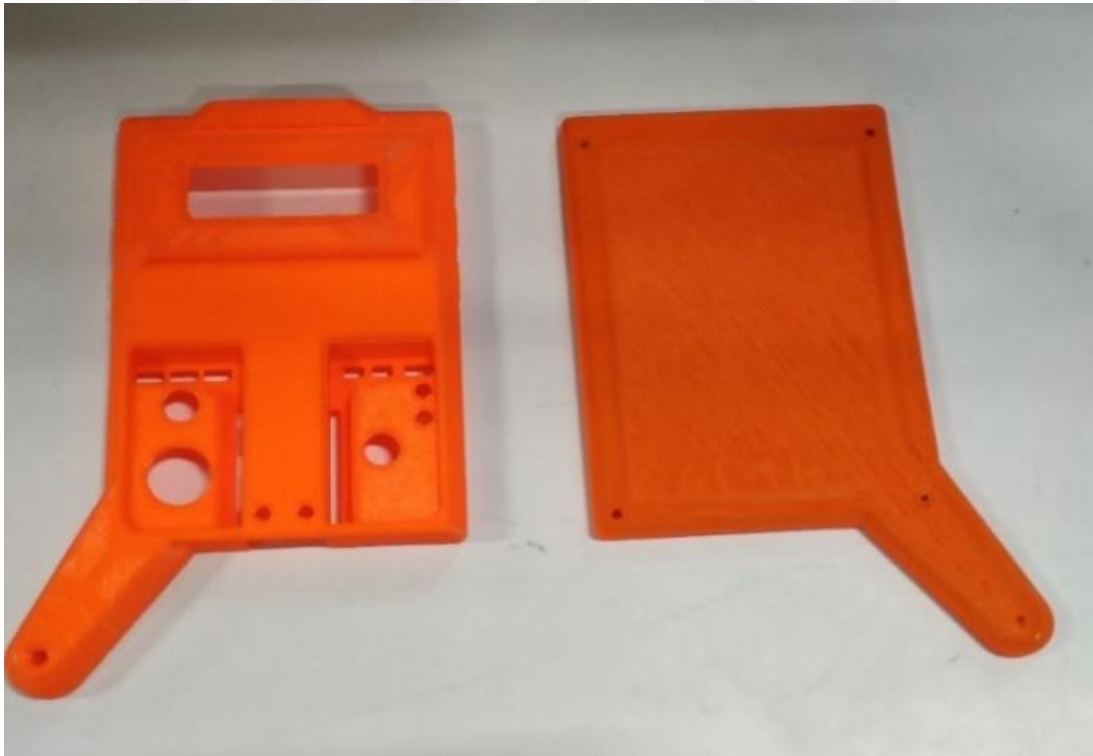
Şekil 5.22. Üç boyutlu yazıcıdan imal edilmiş dış kabuğun görüntüsü.
