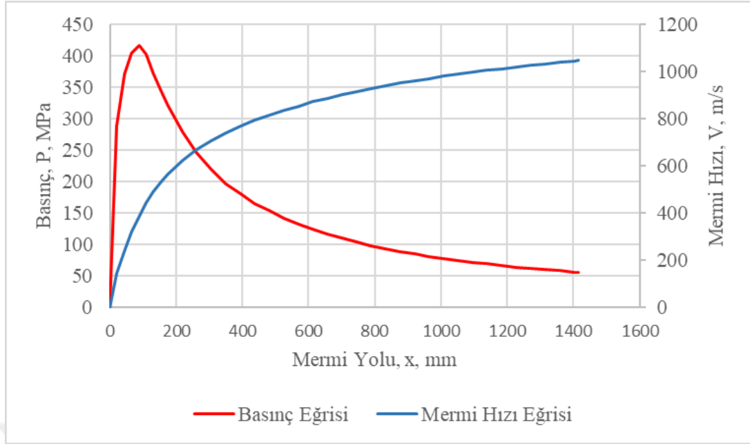
Şekil 2.13. Basınç ve Mermi hızı arasındaki ilişki (Şahin ve Özdemir, 2021).
