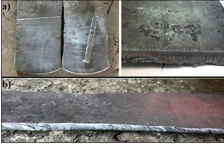
Şekil 4.5. Dövme işlemi sonrası çelik saclara ait görüntüler; a) 15 mm, b) 5 mm
