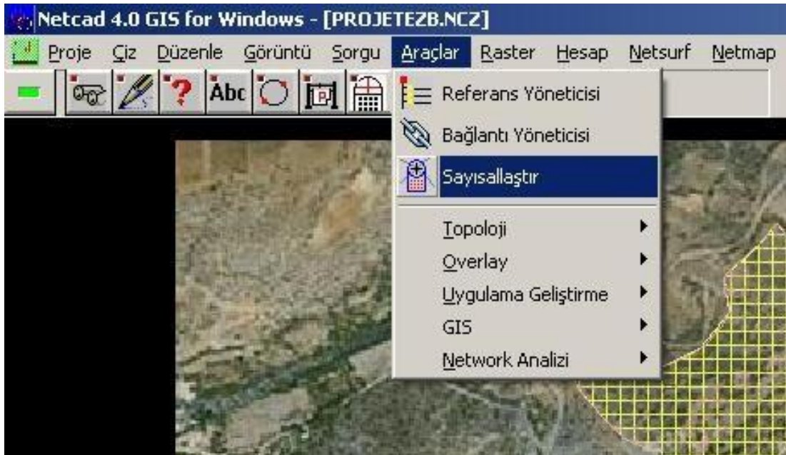
Şekil 3.21 Çizilmiş alanların sayısallaştırılması
