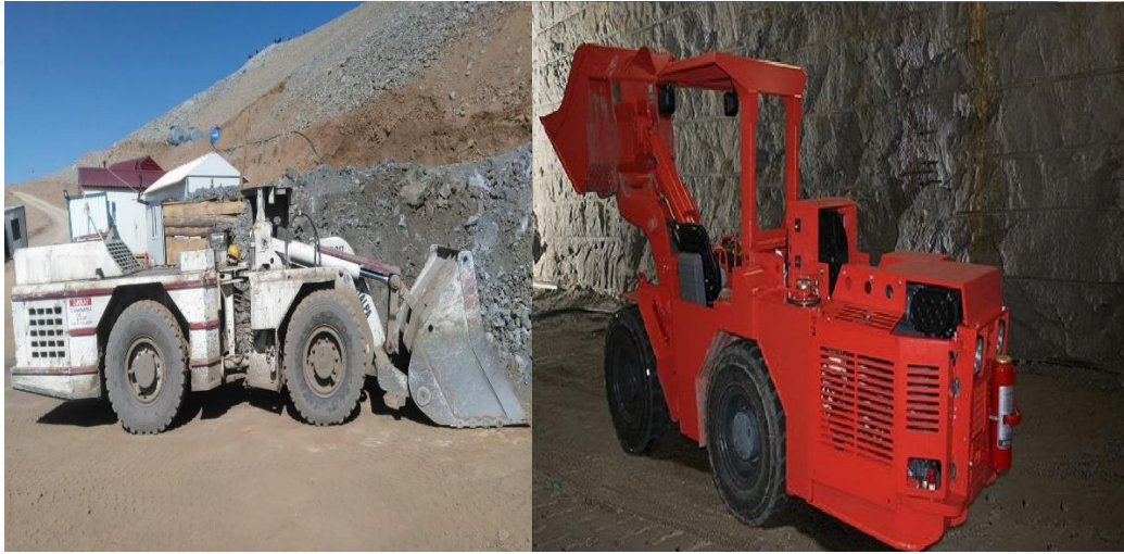
Şekil 4.10. Üretim panolarında elde edilen madeni lastikli yer altı yükleyicilerle yükleme noktalarına taşınmaktadır.
