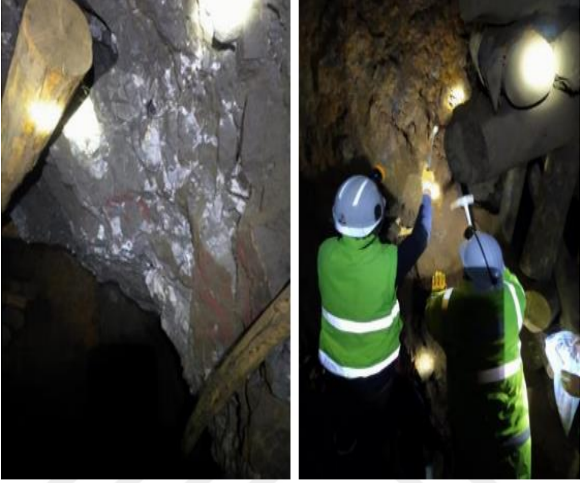
Şekil 1.5. Kızıltepe maden yatağında açılmış olan galeriler içerisinde gözlenen ahşap tahkimatlar (sol ve sağdaki şekiller). Soldaki galeri tavanında yan kayaç parçalarını içeren breşik ve masif yapılı birincil hematit cevheri ile sağdaki şekilde galeri aynasında ikincil nitelikteki toprağımsı limonitik karstik cevherlerden numune alım çalışmalarından görüntüler.
