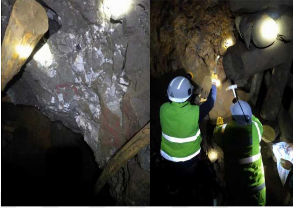
Şekil4.9. Kızıltepe maden yatağında açılmış olan galeriler içerisinde gözlenen ahşap tahkimatlar (sol ve sağdaki şekiller). Soldaki galeri tavanında yan kayaç parçalarını içeren breşik ve masif yapılı birincil hematit cevheri ile sağdaki şekilde galeri aynasında ikincil nitelikteki toprağımsı limonitik karstik cevherlerden numune alım çalışmalarından görüntüler.
