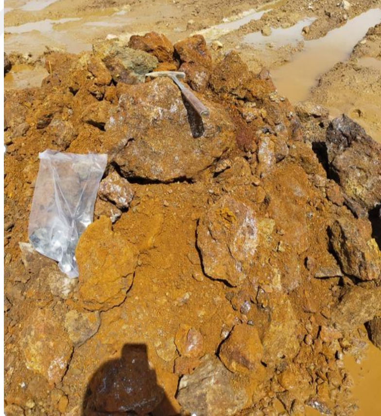
Şekil 4.24. Ocak önünde bekletilen ikincil cevher numune alınarak ilgili tenör aralığı belirlenmektedir. İnce taneli olduğu gibi iri takozlar halinde de bulunabilmektedir.
