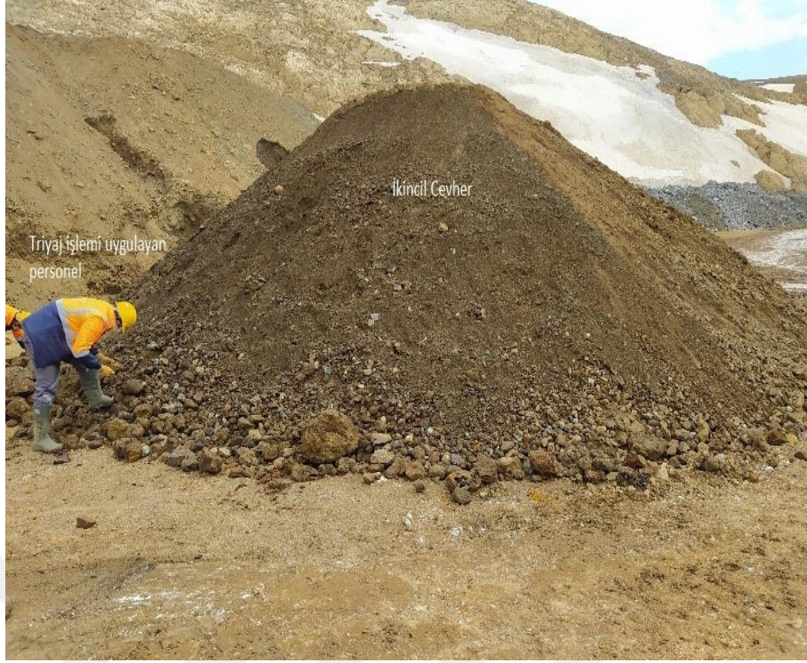
Şekil 4.23. Ocak önüne çıkartılan ikincil cevher triyaj işlemi uygulanarak yüklemeye hazır hale getirilmektedir.
