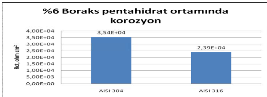
Şekil 3.198. %6 Boraks pentahidrat AISI 304, AISI 316 korozyon karşılaştırma.
