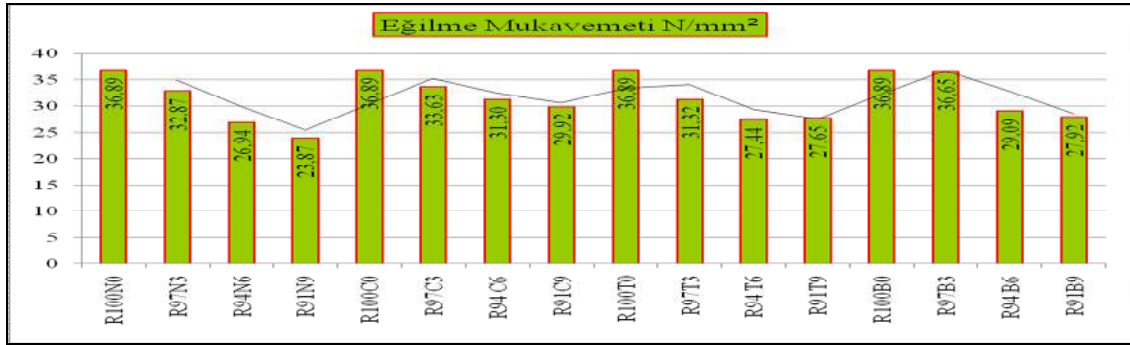
Şekil 3.128. Fabrika üretiminde Kaya tuzu, Kalsit, Talk ve Boraks pentahidrat’%0, %3, %6, %9 inorganik dolgu katkılı levhaların eğilme mukavemeti sonuçları.
