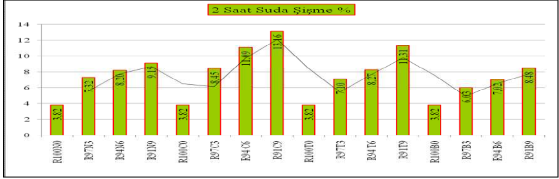
Şekil 3.68. Fabrika ortamında Kaya tuzu, Kalsit, Talk ve Boraks pentahidrat'ın %0, %3, %6, %9 inorganik mineral katkılı levhaların iki saat suda şişme yüzdelerinin sonuçları.
