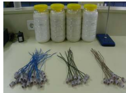
Şekil 2. 13. Deneyde kullanılan elektrotların hazırlanışı. Deney örnekleri (Foto: Çamlıbel, O).
