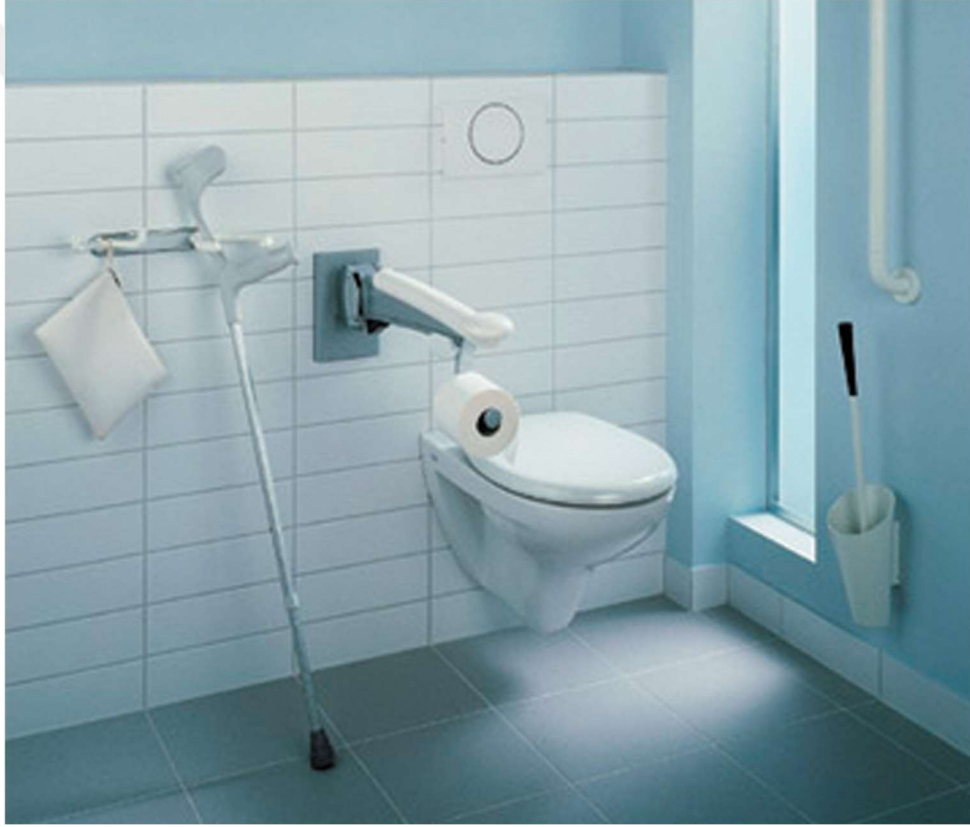
Görsel 2.6. Klozet destek kullanımı için örnek (Erkılıç, vd., 2006, s. 17)
