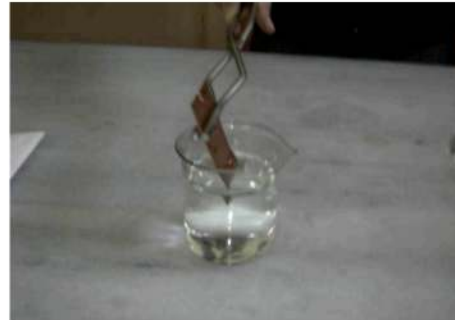
Anot beherden alınır, alkole daldırılır, kağıt üzerine bırakarak kurutulur ve tekrar tartılır.
