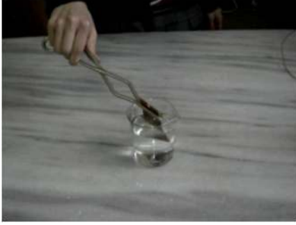
Elektrot 2-3 saniyelik HNO 3 'e hızla daldırılır.
