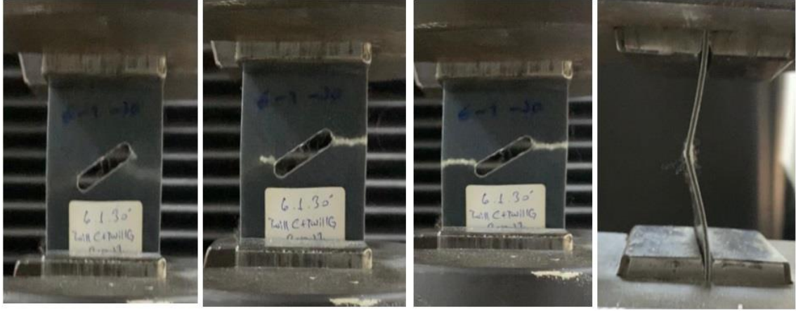
Şekil 5.20. 6.Grup (2G+4C+2G_TT) numunelerinden 30° çentik açılı numunenin hasar anı görselleri
