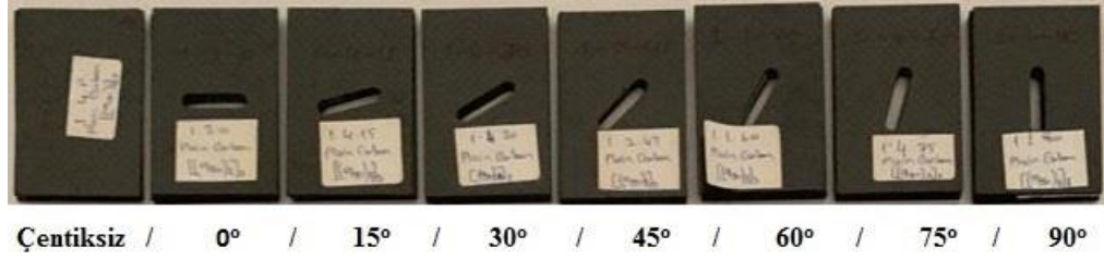
Şekil 4.6. 1.Grup numunelerin çentik açılarını detaylı gösteren görsel
