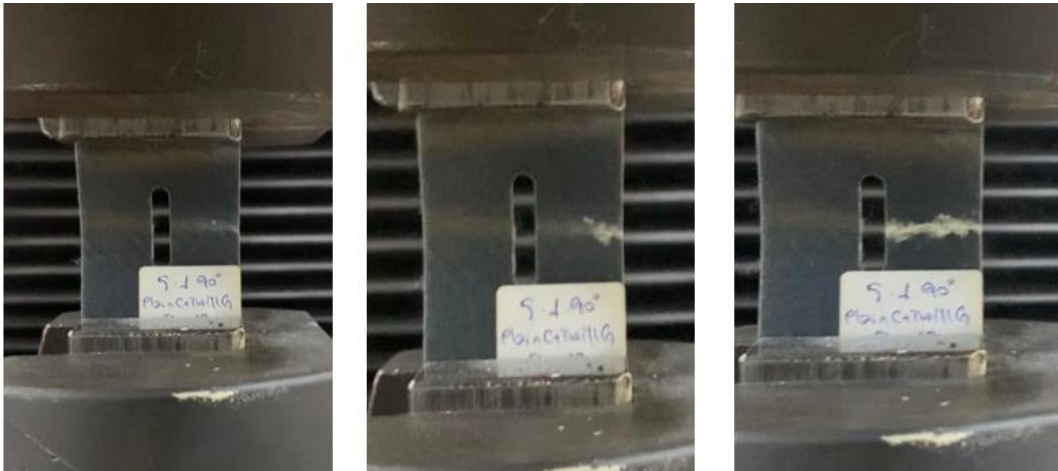
Şekil 5.17. 5.Grup (2G+4C+2G_PT) numunelerinden 90^\circ çentik açılı numunenin hasar anındaki görselleri
