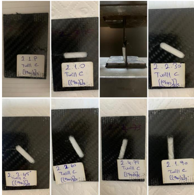
Şekil 5.10. 1.Grup (8C_P) çentiksiz ve 0°, 15°, 30°, 45°, 60°, 75°, 90° çentik açılı numunelerin hasar sonrası görselleri
