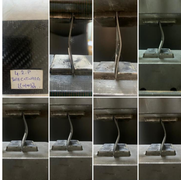
Şekil 5.13. 4.Grup (2C+4G+2C_TT) çentiksiz ve 0°, 15°, 30°, 45°, 60°, 75°, 90° çentik açılı numunelerin hasar sonrası görselleri
