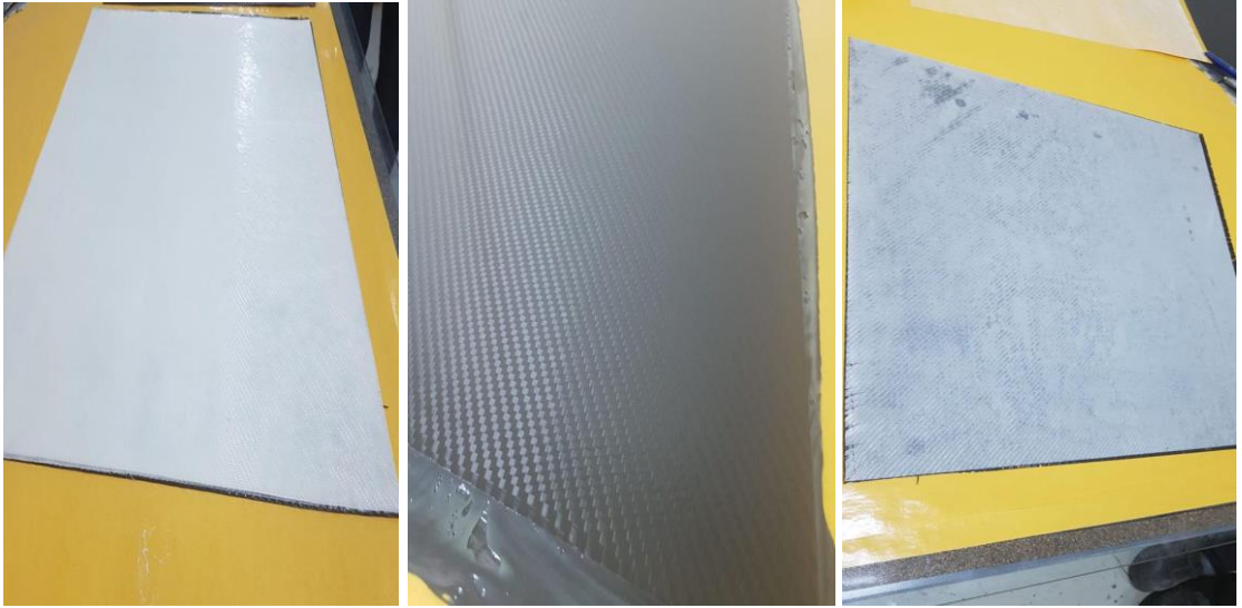
Şekil 4.4. Elyaf tabakalarının tezgâha yatırıldığı soğumaya bırakıldığı görselleri
