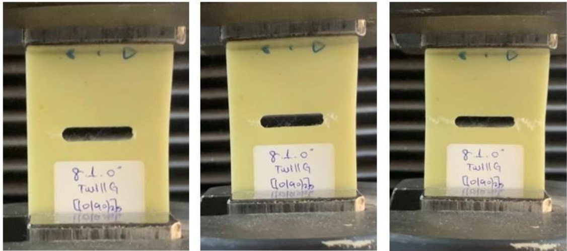
Şekil 5.34. 8.Grup (8G_T) numunelerinden 0^\circ çentik açılı numunenin hasar anı görselleri
