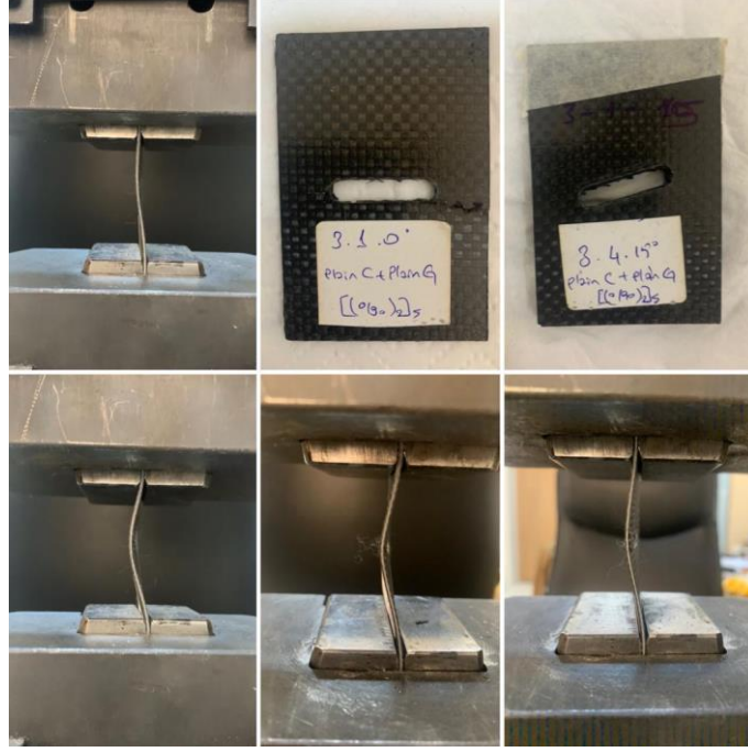
Şekil 5.12. 3.Grup (2C+4G+2C_PP) çentiksiz ve 0°, 15°, 30°, 45°, 60°, 75°, 90° çentik açılı numunelerin hasar sonrası görselleri
