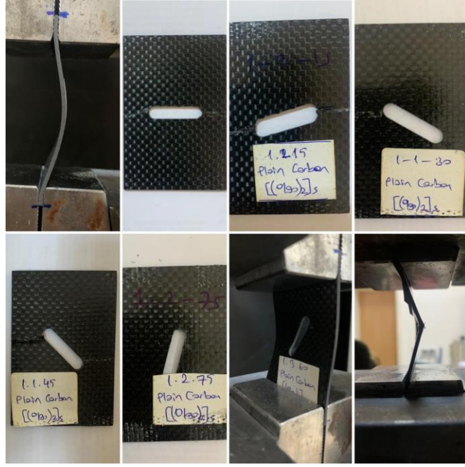
Şekil 5.10. 1.Grup (8C_P) çentiksiz ve 0°, 15°, 30°, 45°, 60°, 75°, 90° çentik açılı numunelerin hasar sonrası görselleri
