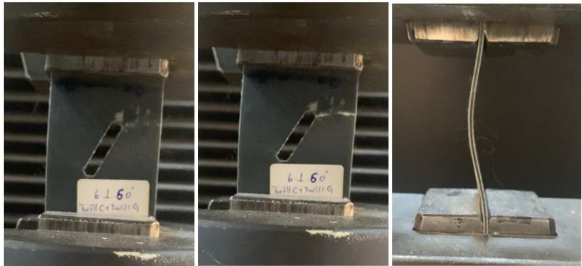
Şekil 5.22. 6.Grup (2G+4C+2G_TT) numunelerinden 60° çentik açılı numunenin hasar anı görselleri
