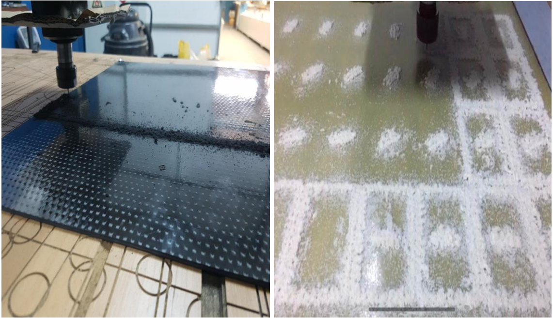
Şekil 4.5. Çentik açılarının belirlenip kesilme anındaki görselleri
