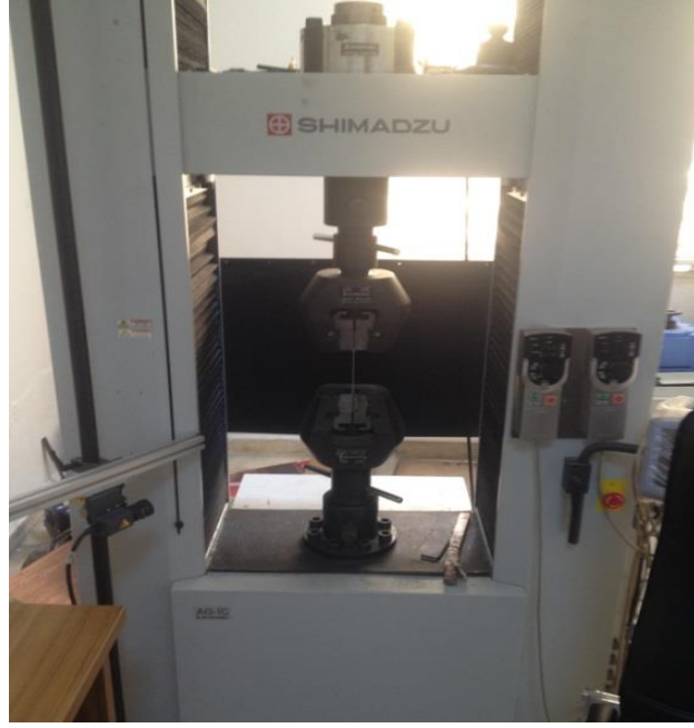
Şekil 4.15. 250 kN yük kapasiteli Shimadzu marka universal test cihazı
