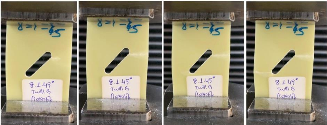
Şekil 5.37. 8.Grup (8G_T) numunelerinden 45° çentik açılı numunenin hasar anı görselleri
