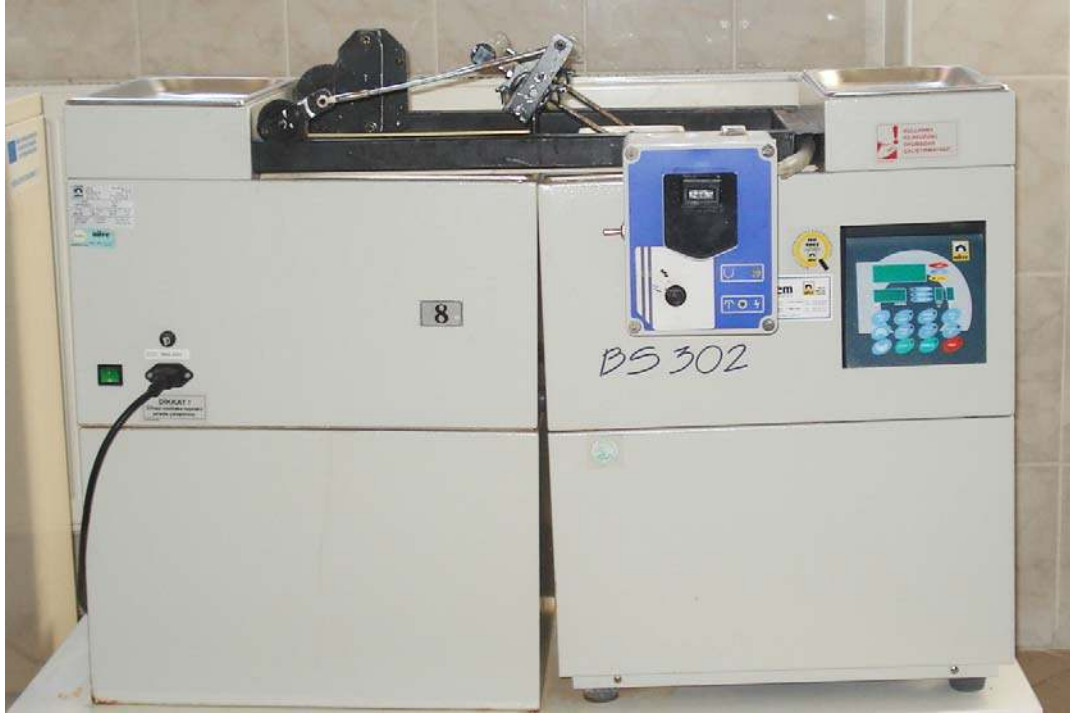
Şekil 3.4. Örneklerin sıcaklık değişimine uğratıldığı termal siklus cihazı.
