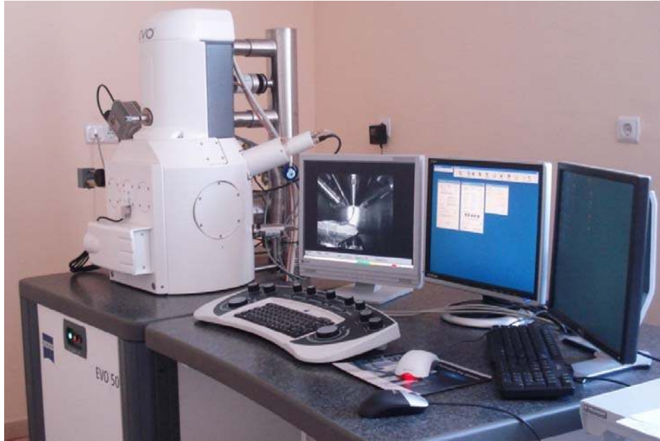
Şekil 3.8. Kantitatif kalsiyum ölçümü yapan SEM ile beraber çalışan EDS cihazı.
