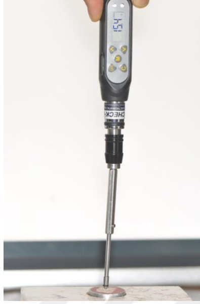
Şekil 3.19. Maksimum yerleştirme torkunun ölçülmesi (90° yerleştirme açısı)
