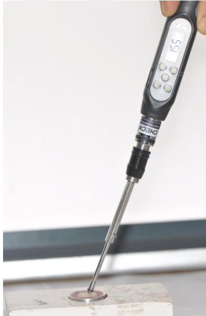
Şekil 3.18. Maksimum yerleştirme torkunun ölçülmesi (60° yerleştirme açısı)
