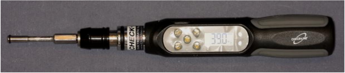
Şekil 3.10. Dijital tork ölçer tornavida (Checkline TSD 50, ABD)
