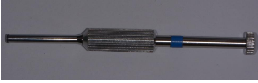
Şekil 3.7. Abso-Anchor mini vidalar için kullanılan tornavida
