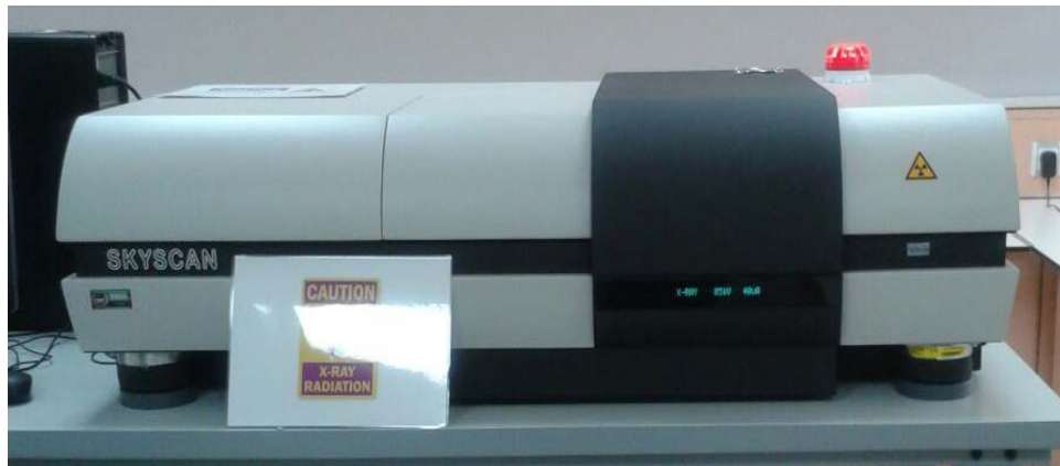
Resim 2. Mikro BT Cihazı (Skyscan 1172, Bruker, Belgium).
