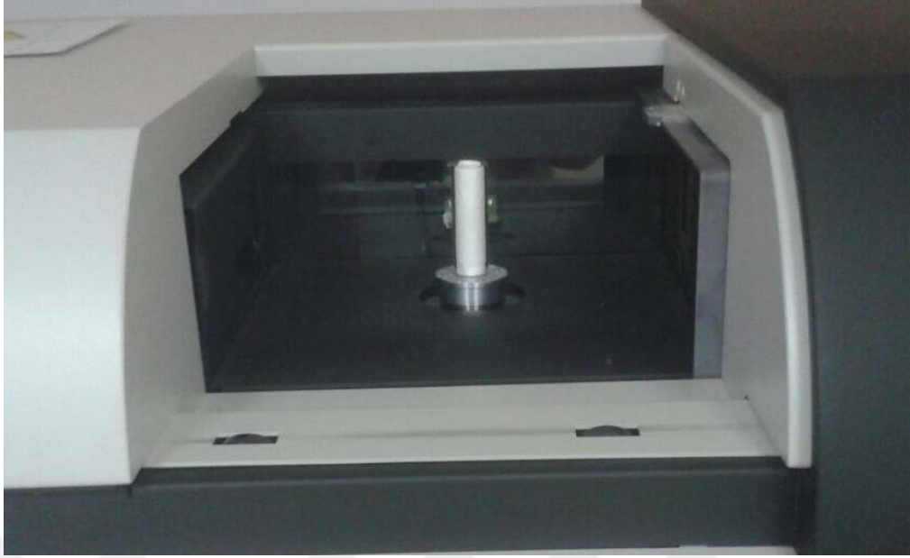
Resim 3. Cihazın iç haznesine sabit pozisyonda durması için peçete rulosu içine yerleştirilmiş olan örnek dişin görünümü.
