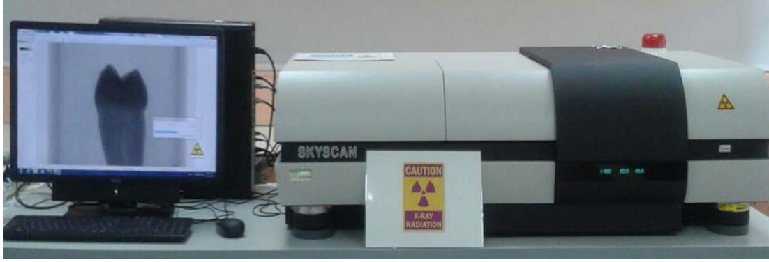
Resim 5. Örnekler mikro BT cihazı ile taranırken elde edilen görüntü verileri bilgisayar ortamında kaydedilir.
