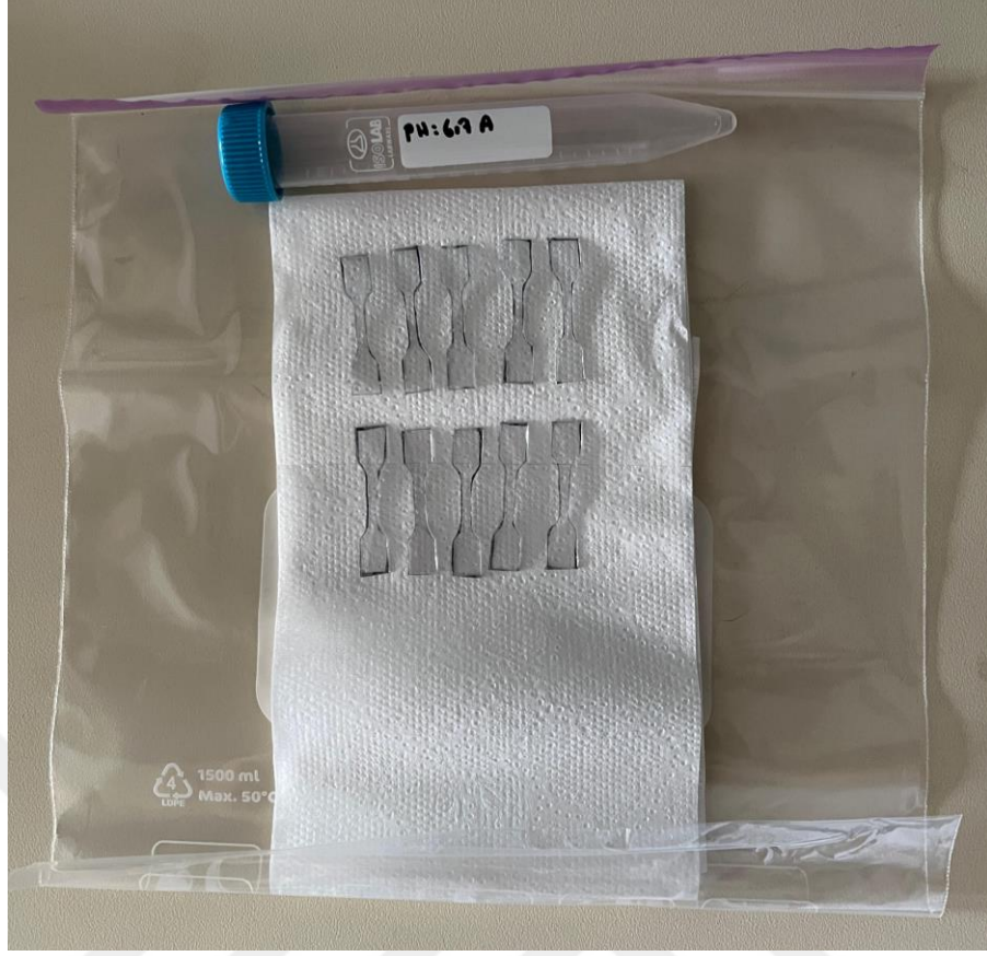
Fotoğraf 3.11. Çekme testi için kesilmiş numunelerin 14 günlük bekletme sonunda kurumaya bırakılması
