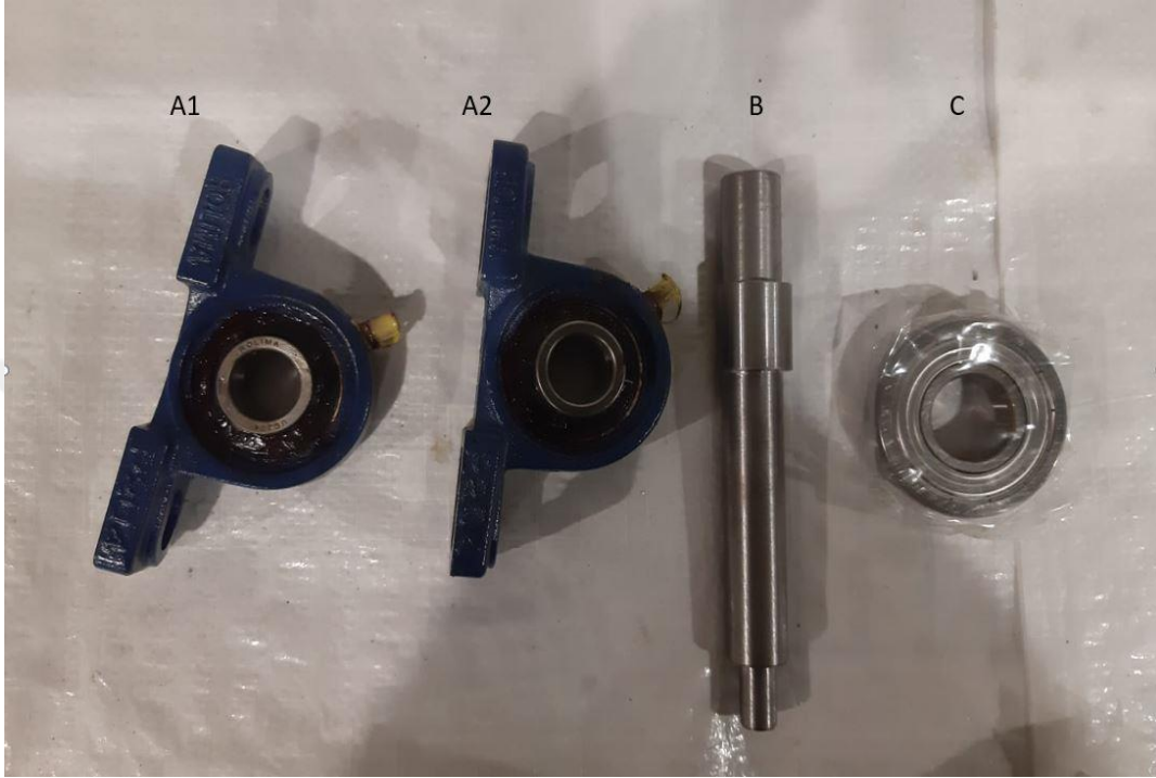
Şekil 11 - Eksantrik kısım parçaları A1-A2) Mıl rulmanları , B) Eksantrik mıl , C) Aktarım rulmanı
