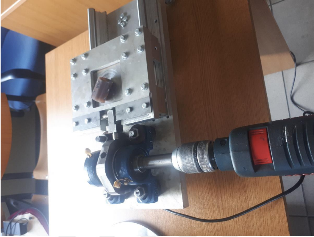
Şekil 16 - Tasarlanan junker test makinası çalışırken
