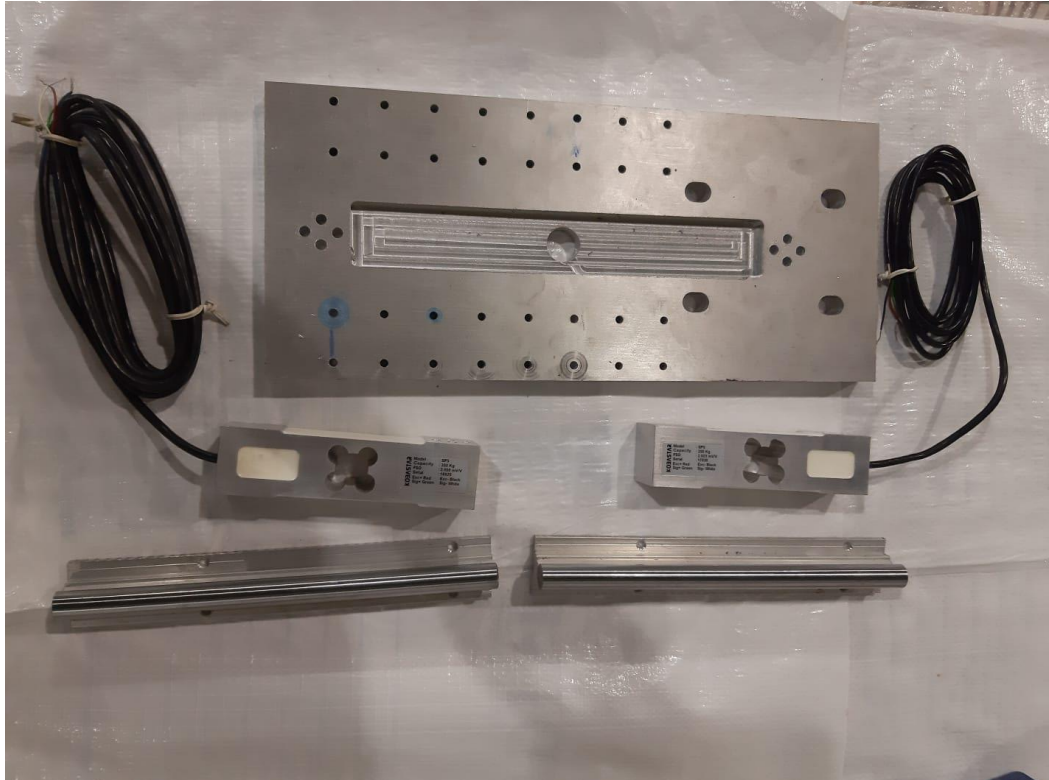
Şekil 13 - Alt tabla ve yük hücreleri ve kızakların taşlanmış milleri
