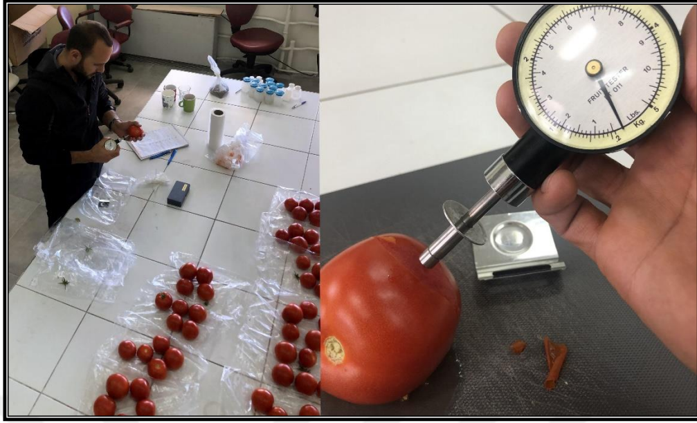
Şekil 3.15. Meyve eti sertlik ölçümlerinde genel bir görünüm
