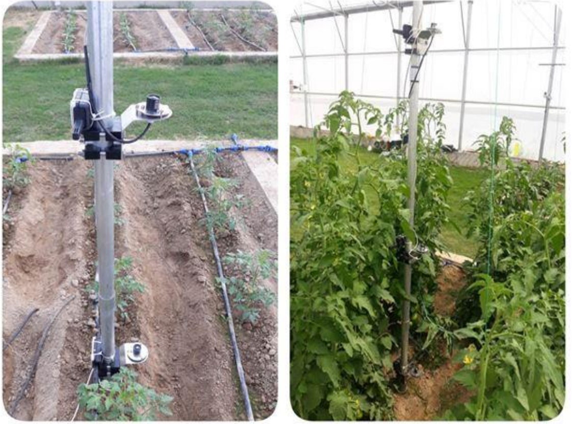
Şekil 3.8. PAR quantum ve sıcaklık-nem ölçüm sensörlerinin konumlarının görünümü
