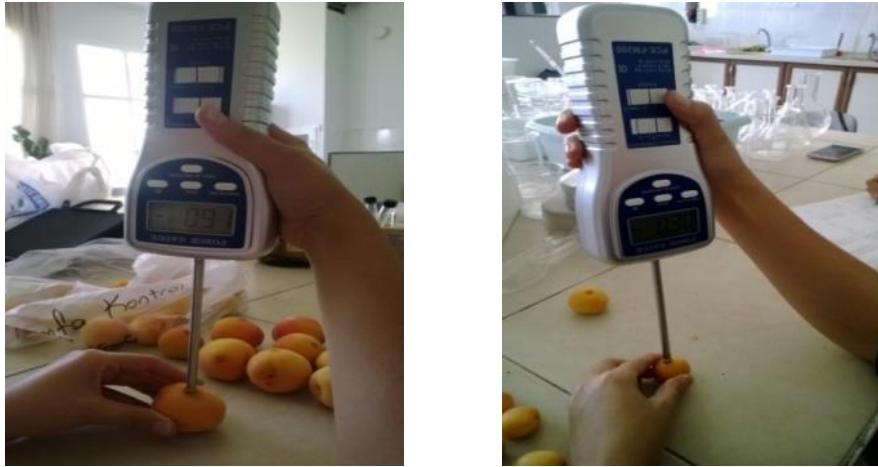
Şekil 3.22. Meyve eti sertliğinin digital penetrometreyle ölçümü
