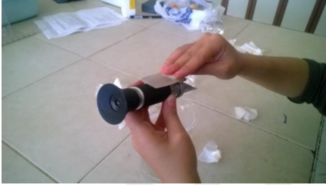
Şekil 3.23. Meyvelerde refraktometre ile SÇKM ölçümü
