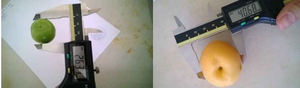
Şekil 3.21. Meyvede en-boy-yükseklik ölçümü
