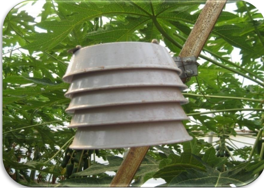
Şekil 3.3. Mini Meteoroloji İstasyonu (HOBO)'dan genel görünüm
