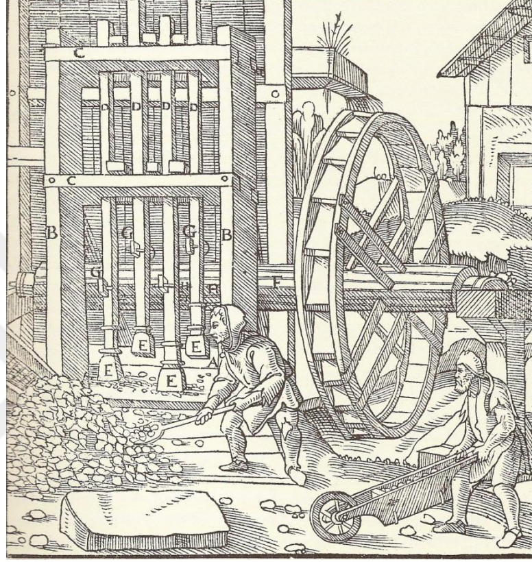
Resim 28- Maden cevherinin, üstten çevirmeli çarklarla tahrik edilen tokmak çekiçlerle kırılması (Agricola).
