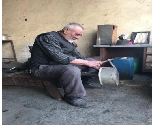
Fotoğraf 1.17: Ahmet Bilge'nin Kalay Öncesi Yamulan Tencereyi Düzeltmesi
