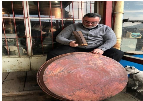
Fotoğraf 1.25: İsmail Yıldız'ın Bakır Leğeni Tahta Tokmakla Düzeltmesi
