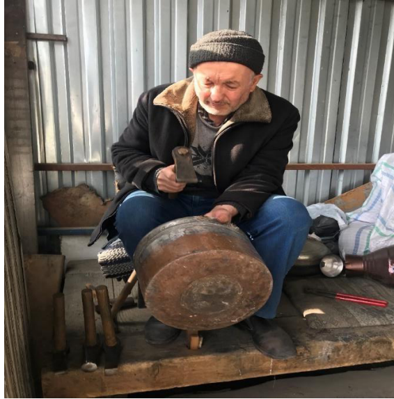
Fotoğraf 1.30: Bilal Çorbacı'nın Elinde Bakır Kazanın İşlenmeye Başlaması
