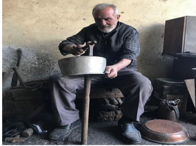
Fotoğraf 1.18: Ahmet Bilge Bey'in Kalaylama Öncesi Çukurlukları Düzeltmesi
