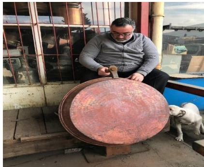
Fotoğraf 1.22: İsmail Yıldız'ın Bakır Kazanı İçe Kıvrarak Düzeltmesi
