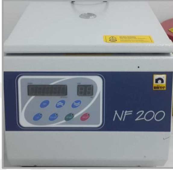
Şekil 36. Deneklerin kalplerinden alınan kanların santrifüj edildiği santrifüj cihazı.
