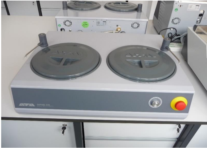
Resim 3.3. Çalışmalarda kullanılan ATM Sapphire 330 zımparalama ve parlatma cihazı
