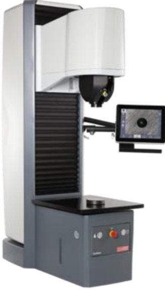
Resim 3.8. Sertlik deneylerinde kullanılan Emtctest Duravision 200 Model Sertlik Cihazı
