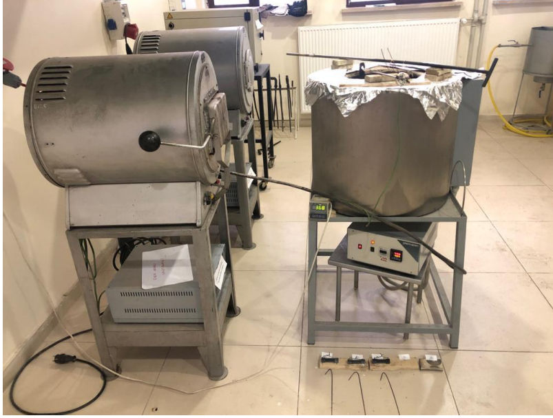
Resim 3.1. Isıl işlemlerde kullanılan fırın ve tuz banyosu
