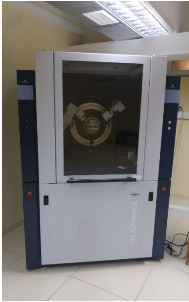
Resim 3.6. Çalışmalarda kullanılan Bruker D8 Advance XRD cihazı
