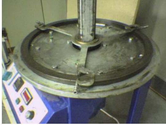
Şekil 7.15 Üç numunenin bağlandığı ayak mekanizması
