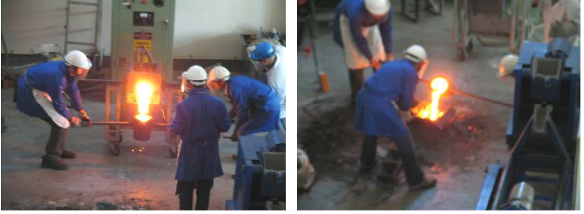
Şekil 8.18 Tırnak dökümü: (a) eriyiğin indüksiyon ocağından proses potasına alınışı, (b) kum kalıba döküm anı
