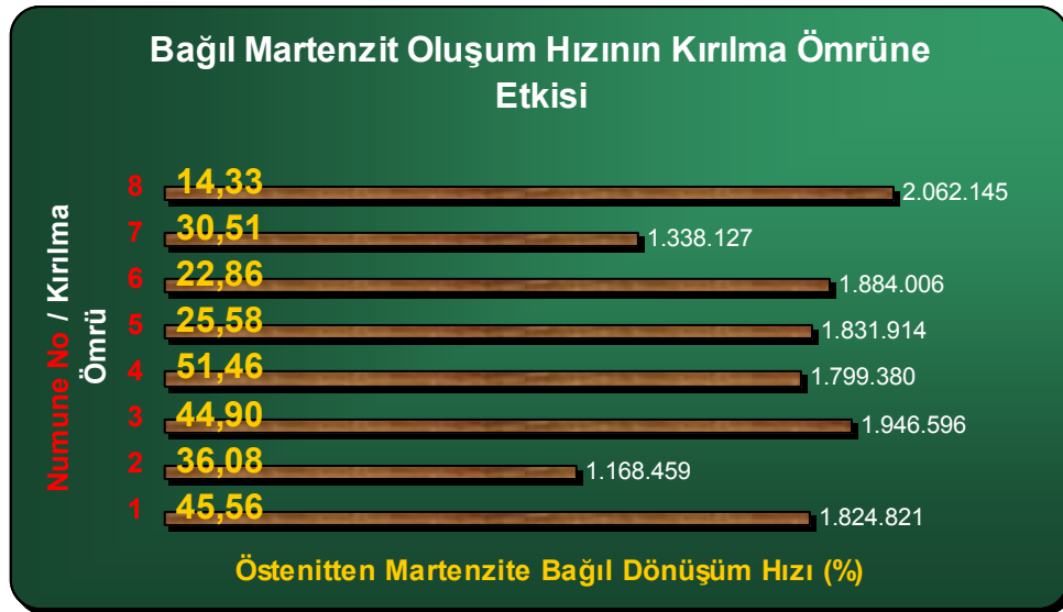
Şekil 8.14 250.000 devirde alınan sonuçlara göre bağıl martenzit oluşum hızının kırılma ömrüne etkisi
