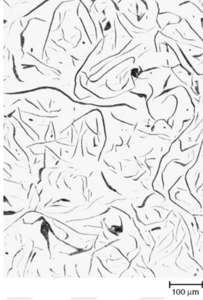
Şekil 1.4 Gri dökme demirin mikroyapısı (ASM 1, 1993)
