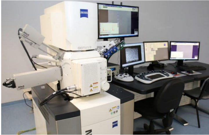
Resim 5.6. Carl Zeiss Merlin taramalı elektron mikroskobu
