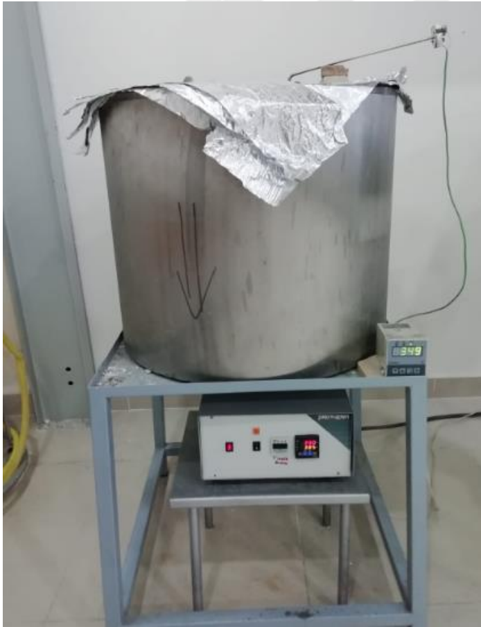
Resim 5.2. Östemperleme ısı işlemlerinde kullanılan Protherm marka tuz banyosu
