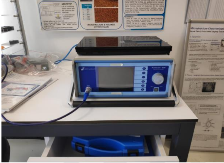
Resim 5.8. Manyetik Barkhausen gürültü ölçümlerinde kullanılan Stresstech Rollscan 300 model cihaz
