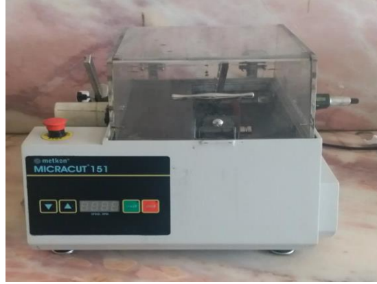
Şekil 4.1 Hassas Kesme Cihazı
